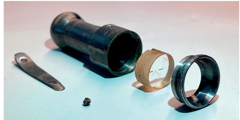
Die Feder „C1“ ist im Vergleich zur Größe des Fadenkreuzmodul ziemlich stark. Sie hat eine Dicke von 0,8 mm !
