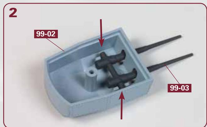
Setzen Sie die Rohre **99-03** so in den MA-Turm **99-02** ein, dass die Zapfen der Wiege in den Aussparungen des Turms ruhen (Pfeile).
