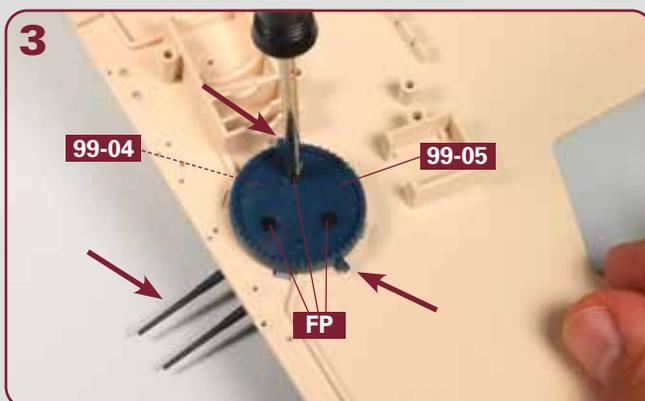
Setzen Sie das Zahnrad **99-05** auf die Grundplatte **99-04** und befestigen Sie es mit den drei Schrauben **FP**. Achten Sie dabei unbedingt auf die Ausrichtung der beiden Teile zueinander, siehe Pfeile.
