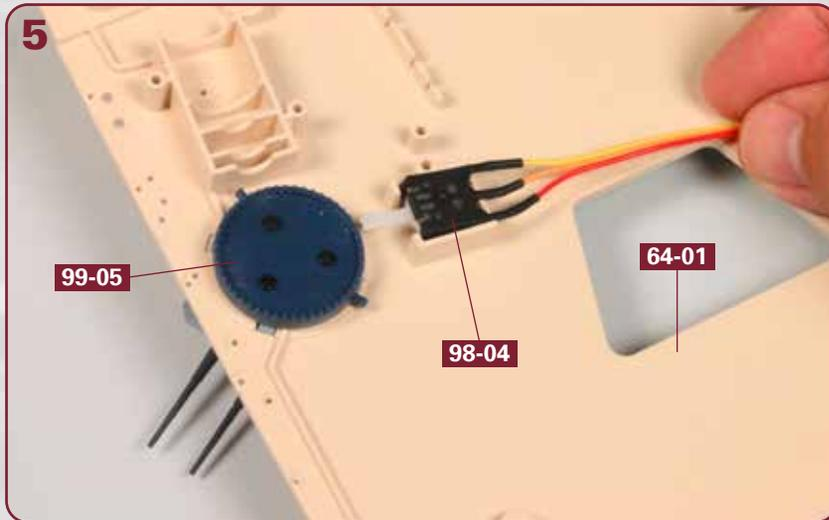
Platzieren Sie den Endschalter **98-04** nahe des Zahnrads **99-05** in der Aussparung an der Unterseite des Oberdeckabschnitts **64-01**.
