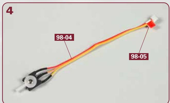
Kleben Sie die Kabelmarkierung **98-05** am Kabel des Endschalters **98-04** fest.
