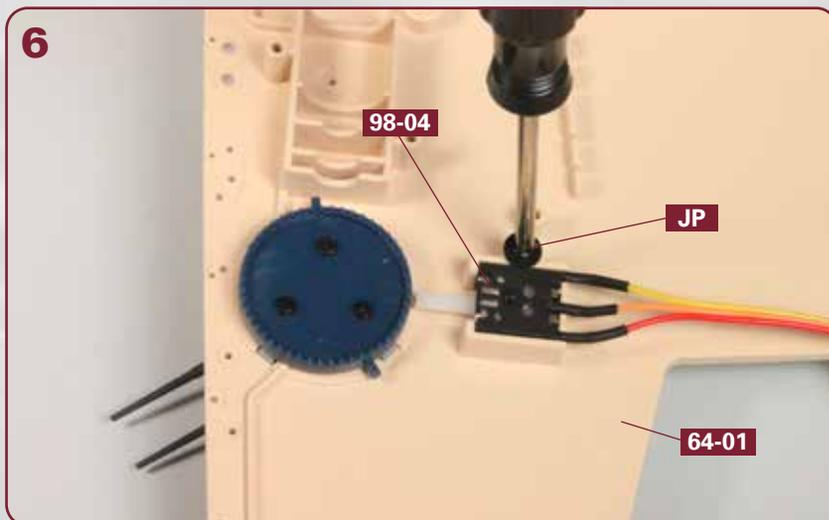
Fixieren Sie den Endschalter **98-04** mit einer Schraube **JP** an der Unterseite des Oberdeckabschnitts **64-01**.
