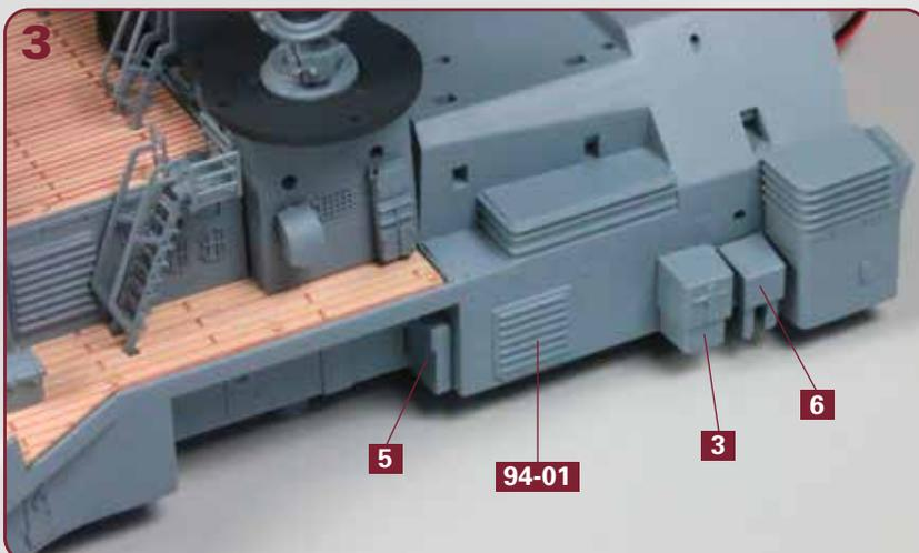
Direkt neben dem Kasten **6** wird der Schrank **3** an der Struktur **94-01** fixiert. Etwas weiter achtern wird an dem kleinen Wandrücksprung das Schränkchen **5** festgeklebt, wie es das Foto zeigt.
