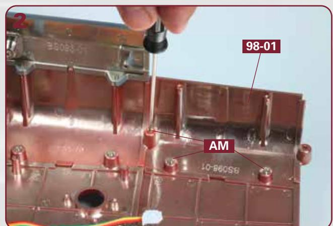
Befestigen Sie den rechten unteren Rumpfabschnitt **98-01** mit drei Schrauben **AM** an der Rumpfstruktur, wie abgebildet.
