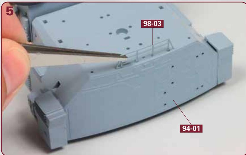
Kleben Sie die Reling **98-03** vorne mittig auf der Struktur **94-01** (dem Hangardach) fest: Geben Sie dazu etwas Klebstoff auf die Relingpfosten und fügen Sie diese in die Löcher auf dem Dach ein, wie abgebildet.
