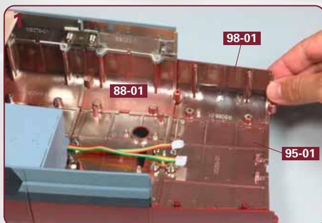
Nehmen Sie den rechten unteren Rumpfabschnitt **98-01** und fügen Sie seine drei Zapfen in die Bohrungen des rechten unteren Rumpfabschnitts **88-01** und des Kielabschnitts **95-01** ein.
