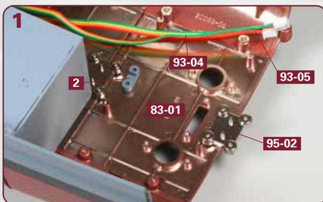
1 Entfernen Sie die hinterste Kabelführung **2** zeitweilig, sodass Sie die beiden Kabelverlängerungen **93-04** und **93-05** zur Seite schieben können. Setzen Sie das Verbindungsstück **95-02** auf die beiden Zapfen des neunten Kielabschnitts **83-01**.
