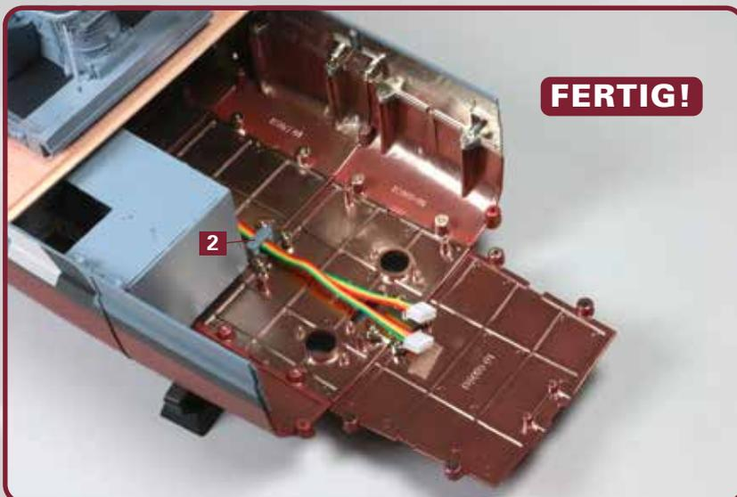
**Das Bauergebnis dieser Ausgabe:** Der zehnte Kielabschnitt wurde an der Rumpfstruktur fixiert. Führen Sie die beiden Kabelverlängerungen wieder zurück in die Schiffsmitte und setzen Sie die Kabelführung **2** wieder auf, wie es das Foto zeigt.
