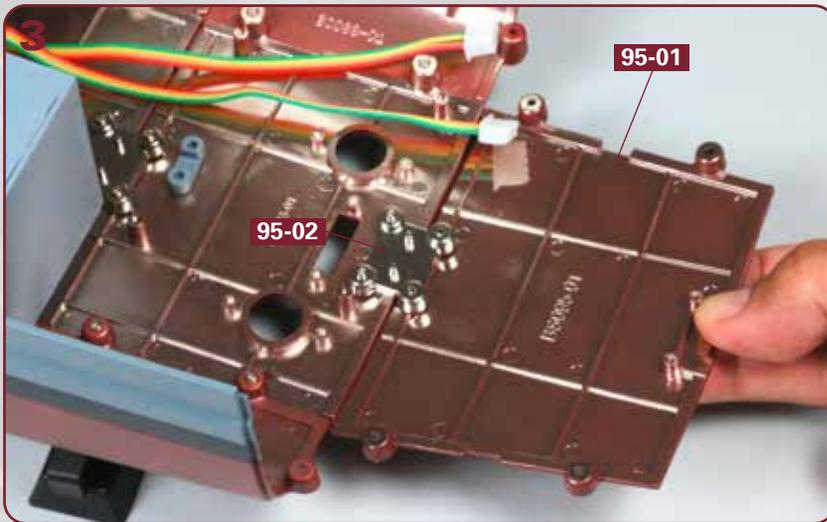
Nehmen Sie den zehnten Kielabschnitt **95-01** und fügen Sie seine vorderen beiden Zapfen von unten in die Löcher des Verbindungsstücks **95-02** ein, wie abgebildet.
