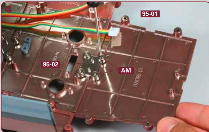
Befestigen Sie den Kielabschnitt **95-01** mit zwei Schrauben **AM** am Verbindungsstück **95-02**.
