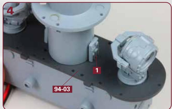
Das zweite Teil **1** wird auf der anderen Seite des Flakleitstands auf der Plattform **94-03** festgeklebt.
