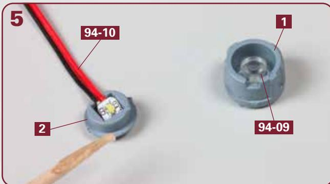
Fügen Sie das LED-Ende des Kabels **94-10** in die Scheinwerfer-Rückwand **2** ein. Achten Sie auf die Ausrichtung der LED! Versehen Sie den Rand der Scheinwerfer-Rückwand **2** mit Sekundenkleber.
