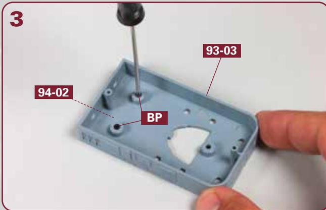
Halten Sie das Decksteil **94-02** in Position und drehen Sie die Struktur um. Fixieren Sie das Decksteil am Haus auf der Deckshausdecke **93-03**, indem Sie die zwei Schrauben **BP** festziehen.
