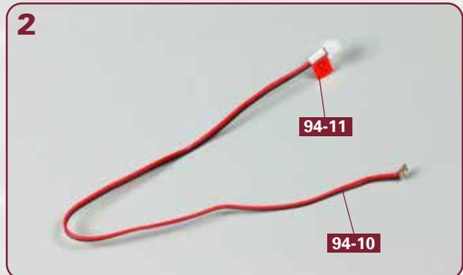
Bringen Sie die Kabelmarkierung **94-11** am Stecker-Ende des LED-Kabels **94-10** an, wie es das Foto zeigt.
