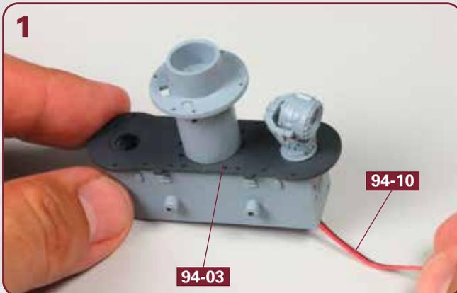
Führen Sie das Kabel **94-10** mit der Markierung C-1 von oben durch das Steuerbord-Loch in der Scheinwerferplattform **94-03**. Kleben Sie den Scheinwerfer auf der Plattform fest, wie abgebildet.
