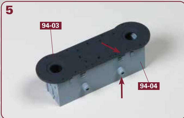
Kleben Sie die Scheinwerferplattform **94-03** auf der Aufbaustruktur **94-04** fest. Achten Sie unbedingt auf die Ausrichtung der Teile zueinander (Pfeile).
