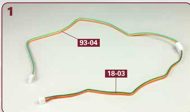
Nehmen Sie das bislang noch gar nicht verwendete Platinen-Kabel **18-03** und fügen Sie einen seiner Stecker in die Buchse der Kabelverlängerung **93-04**, wie abgebildet.
