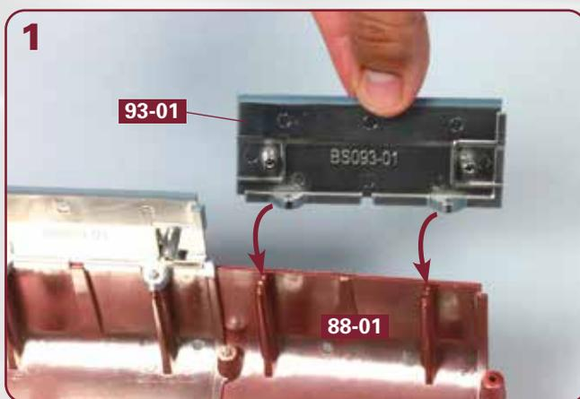
Nehmen Sie den rechten oberen Rumpfabschnitt **93-01** und führen Sie seine beiden Zapfen zu den Bohrungen des Rumpfabschnitts **88-01**, wie es das Foto zeigt.
