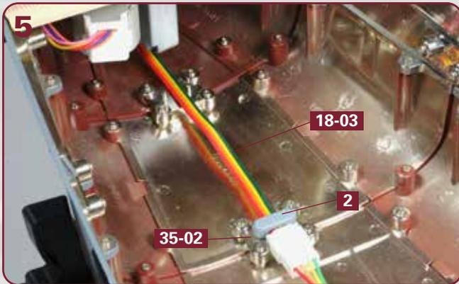
Ziehen Sie das Platinen-Kabel **18-03** vorsichtig in der Rumpfmittle in Richtung Heck. Befestigen Sie die erste Führung **2** (aus dem Rahmen **92-10**) über dem Kabel **18-03** an den Zapfen des Verbindungsstücks **35-02**, wie abgebildet.
