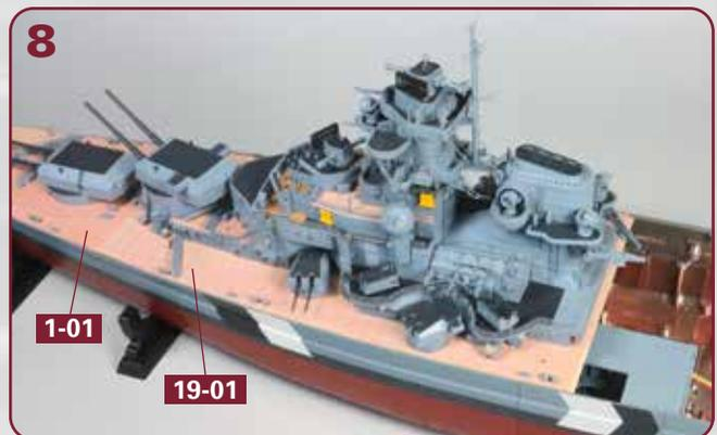
Platzieren Sie die große Oberdeckstruktur **19-01/22-01/48-01** so auf der Rumpfstuktur, dass sie den vorderen Oberdeckabschnitt **1-01** nahtlos fortsetzt, wie abgebildet.
