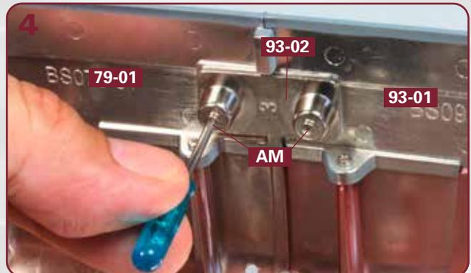
Befestigen Sie das Verbindungsstück **93-02** mit je einer Schraube **AM** an den Rumpfabschnitten **93-01** und **79-01**, wie abgebildet.
