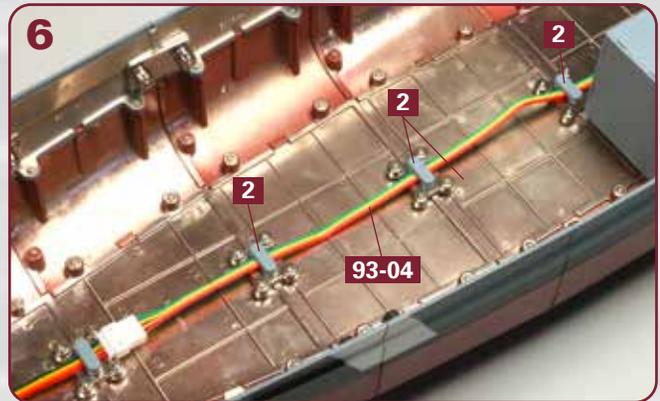
Drei weitere Führungen **2** werden über der Kabelverlängerung **93-04** an den Zapfen der drei, in Richtung Heck nächsten Verbindungsstücke befestigt, wie es das Foto zeigt.
