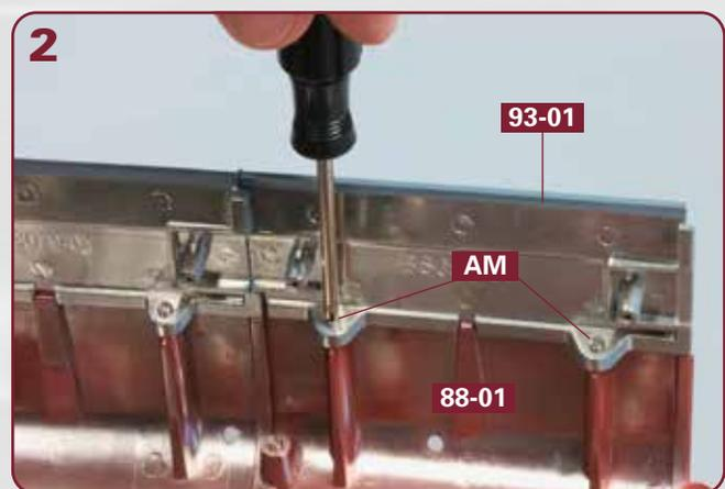
Befestigen Sie den rechten oberen Rumpfabschnitt **93-01** mit zwei Schrauben **AM** am Rumpfabschnitt **88-01**, wie abgebildet.
