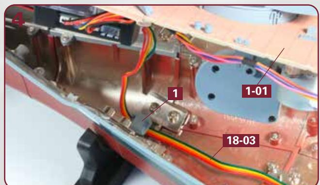
Heben Sie den Oberdeckabschnitt **1-01** leicht an. Führen Sie das Platinen-Kabel **18-03** zum Rumpfboden und setzen Sie über dem Kabel die Führung **1** aus dem Rahmen **92-10** auf.
