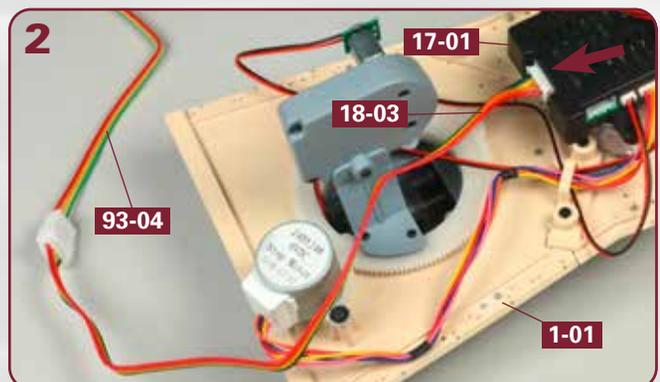
Legen Sie den ersten Abschnitt des Oberdeckes **1-01** verkehrt herum auf Ihre Arbeitsplatte. Verbinden Sie den freien Stecker des Platinen-Kabels **18-03** mit dem Port 4 der Platinen-Box **17-01** (Pfeil).
