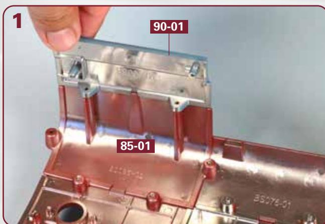
Nehmen Sie den linken oberen Rumpfabschnitt **90-01** und fügen Sie seine beiden Zapfen in die Bohrungen des Rumpfabschnitts **85-01** ein, wie es das Foto zeigt.
