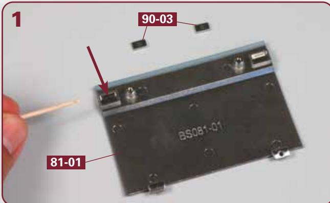
Legen Sie den linken oberen Rumpfabschnitt **81-01** und zwei der Magnete **90-03** auf Ihre Arbeitsplatte. Versehen Sie die linke Vertiefung von **81-01** (Pfeil) mit Sekundenkleber, wie angedeutet.
