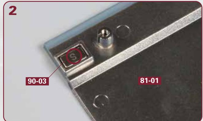
Kleben Sie einen der Magnete **90-03** in der linken Vertiefung des Rumpfabschnitts **81-01** fest. Achten Sie unbedingt darauf, dass die Seite mit dem „S“ (eingekreist) nach oben weist!
