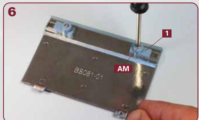
Die zweite Halterung **1** wird am anderen Ende des Rumpfabschnitts aufgesetzt und ebenfalls mit einer Schraube **AM** fixiert, wie abgebildet.
