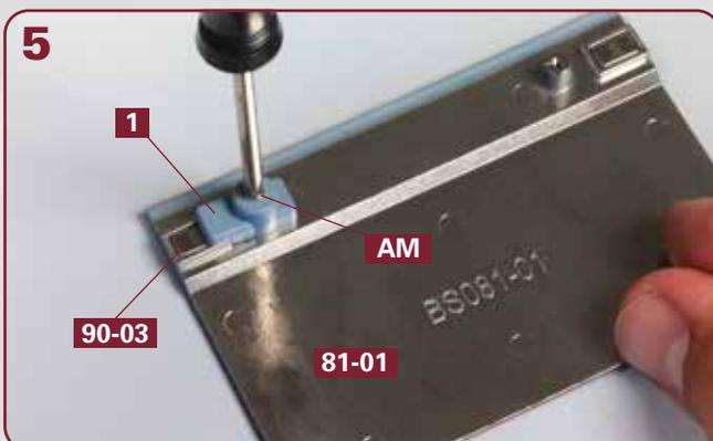
Befestigen Sie die Halterung **1** mit einer Schraube **AM** am Rumpfabschnitt **81-01**. Die Halterung deckt einen kleinen Teil des Magnets **90-03** ab.
