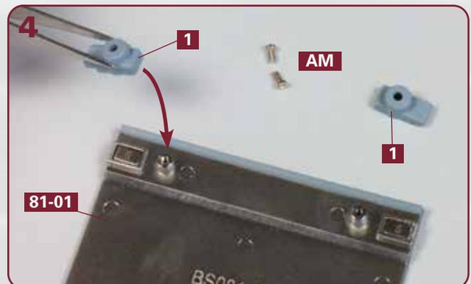
Legen Sie zwei Schrauben **AM** und die beiden Halterungen **1** (Rahmen **90-02**) bereit. Führen Sie eine Halterung **1** zum linken Sackloch von **81-01**.
