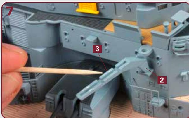
Fügen Sie den Zapfen von Teil **2** in die Bohrung an der Steuerbordseite des Brückendecks ein. Versehen Sie die Oberseite von Teil **3** mit Klebstoff.
