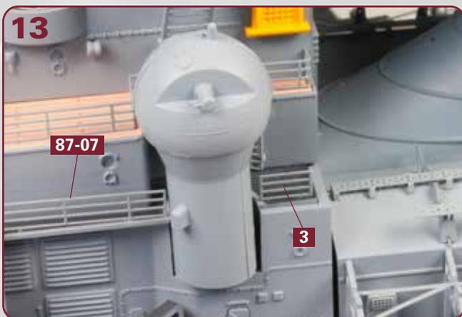
Achtern der Reling **87-07** wird direkt neben dem Flakleitstand die kleine Reling **3** aus dem Rahmen **87-09** festgeklebt.
