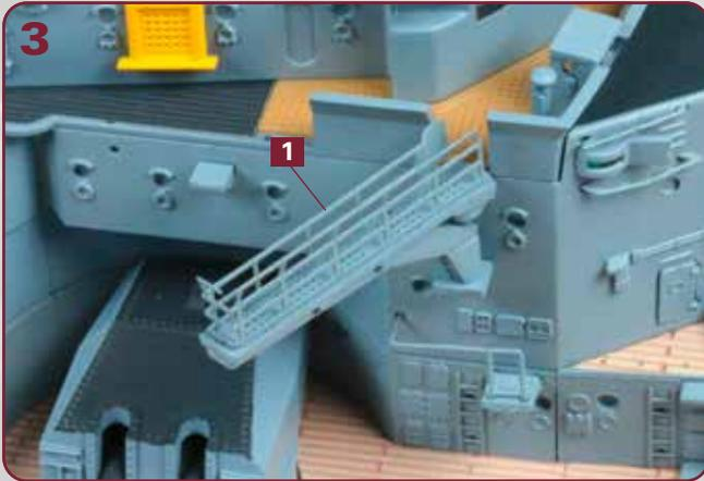
Geben Sie etwas Klebstoff auf die fünf kleinen „Füßchen“ der Reling **1** und kleben Sie diese in den Vertiefungen der Steuerbord-Brückennock fest.
