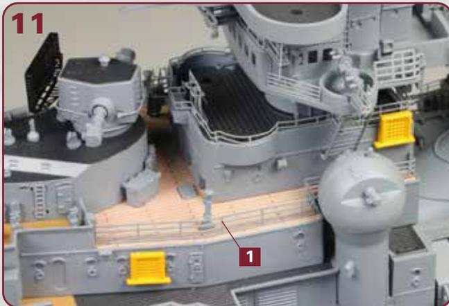
Weiter geht es an Backbord: Auf dem Mastdeck wird die mit den Schritten 3-5 und 3-6 gebogene Reling **1** festgeklebt.
