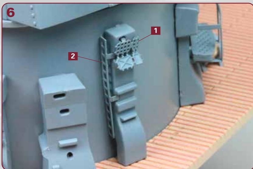
Am Lüfter im steuerbord-vorderen Bereich der Barbette werden die Leiter **2** aus dem Rahmen **85-03** und das Gitter **1** aus dem Rahmen **85-02** festgeklebt, wie es das Foto zeigt.
