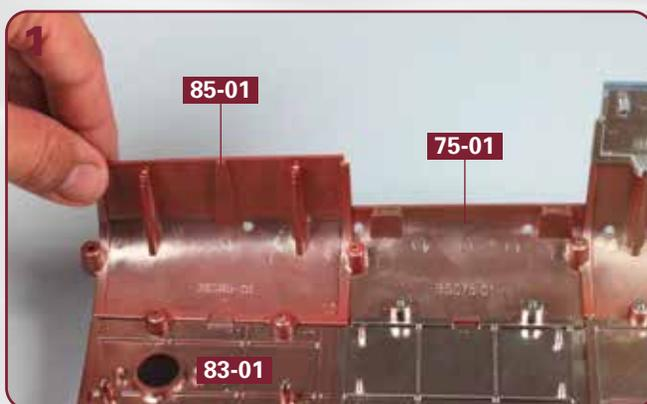
Stellen Sie die Rumpfstruktur so auf Ihre Arbeitsplatte, dass Sie Zugriff auf deren linke Seite haben. Fügen Sie die drei Zapfen vom linken unteren Rumpfabschnitt **85-01** in die Bohrungen der Teile **75-01** und **83-01** ein, wie abgebildet.
