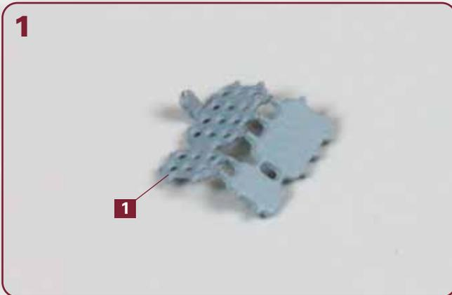
Trennen Sie das Gitter **1** aus dem Rahmen **85-02**. Biegen Sie den „Fuß“ rechtwinklig nach oben. Auch entlang der Mittelstege verleihen Sie dem Teil eine leichte Biegung, wie abgebildet.
