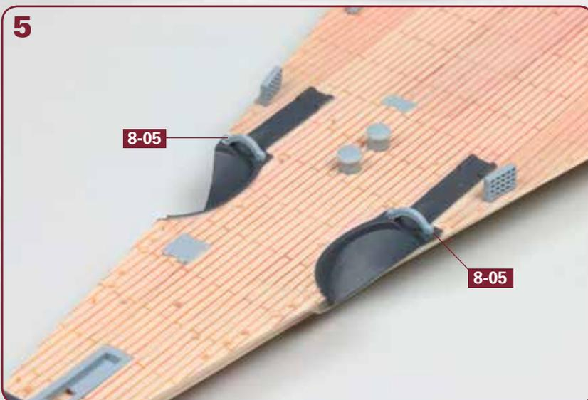
An den Hinterkanten der beiden seitlichen Bugankerklüsen wird jeweils ein Ankerbügel **8-05** montiert. Versehen Sie dazu die Zapfen der Bügel mit etwas Sekundenkleber und fügen Sie sie in die Löcher auf dem Oberdeck ein.
