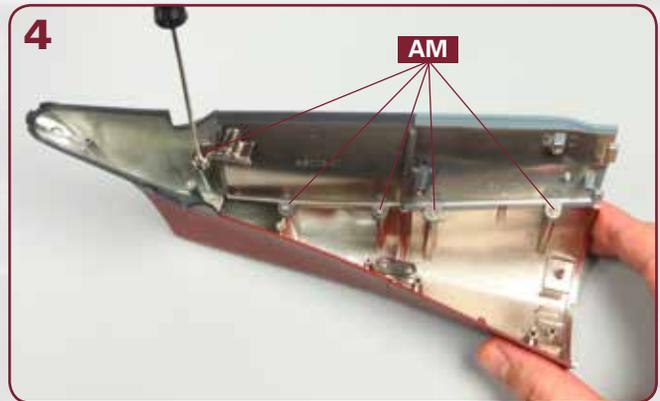
Befestigen Sie die Baugruppe **5-01/8-01** am Rumpf, indem Sie die fünf Schrauben **AM** eindrehen, wie es das Foto zeigt.
