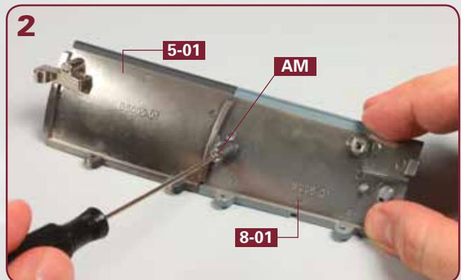
Sind die Zapfen beider Rumpfabschnitte zusammengefügt, befestigen Sie die Teile mit einer Schraube **AM** aneinander. Die beiden Teile sind oben und unten exakt bündig.
