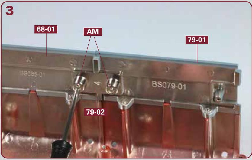
Setzen Sie das Verbindungsstück **79-02** auf die Zapfen der rechten oberen Rumpfabschnitte **68-01** und **79-01**. Befestigen Sie das Verbindungsstück mit zwei Schrauben **AM** an den beiden Rumpfabschnitten, wie es das Foto zeigt.
