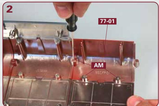
Befestigen Sie den rechten unteren Rumpfabschnitt **77-01** mit drei Schrauben **AM** an der Rumpfstruktur, wie abgebildet.
