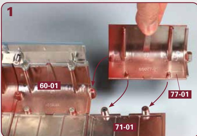
Nehmen Sie den rechten unteren Rumpfabschnitt **77-01** und fügen Sie seine Zapfen von unten in die Aufnahmen des Kielabschnitts **71-01** und des Rumpfabschnitts **60-01** ein, wie angedeutet.
