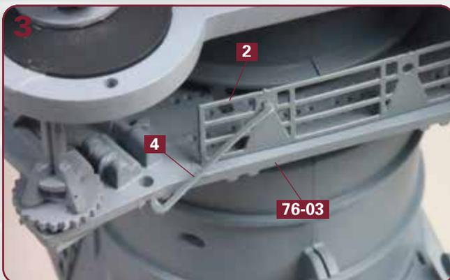
Eine der beiden Stützen **4** aus dem Rahmen **77-02** verläuft von der linken Bohrung der Reling **2** zur linken Vertiefung an der Unterseite der Kranplattform **76-03** und wird dort festgeklebt.
