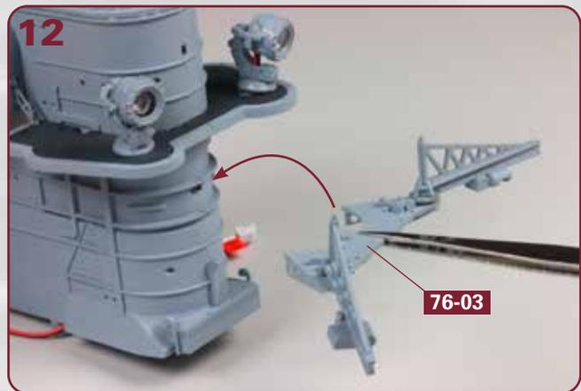
Versehen Sie den zentralen Zapfen der Kranplattform **76-03** mit Klebstoff und führen Sie die Plattform zur Schornsteinrückseite, wie angedeutet.
