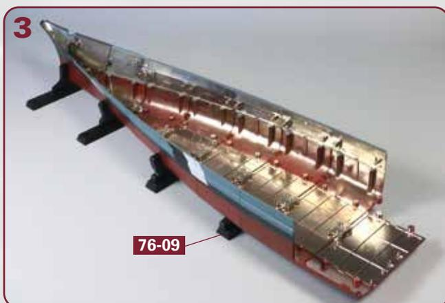
Schieben Sie den Träger **76-09** mit der „Front“-Seite zum Bug weisend unter die Rumpfstuktur, die somit wieder sicheren Halt hat.
