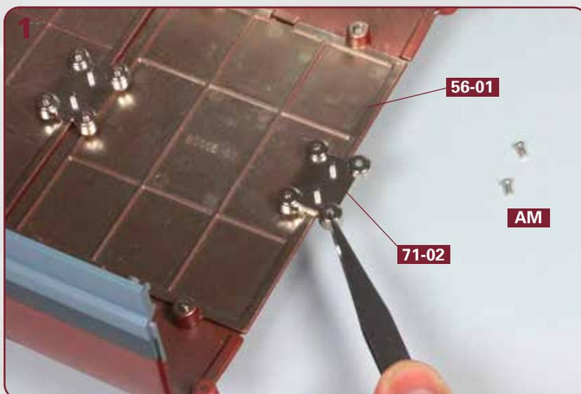
Stellen Sie die Rumpfstruktur so auf Ihre Arbeitsplatte, dass Sie Zugriff auf deren hinteren Bereich haben. Setzen Sie das Verbindungsstück **71-02** auf die beiden Zapfen im hinteren Bereich des siebten Kielabschnitts **56-01**. Legen Sie zwei Schrauben **AM** bereit.
