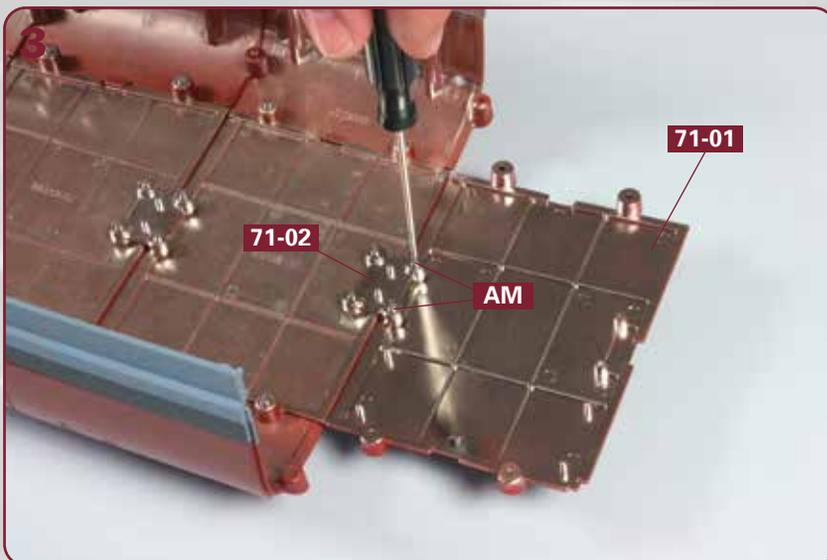
Setzen Sie den Kielabschnitt **71-01** von unten gegen das Verbindungsstück **71-02**. Befestigen Sie beide Teile aneinander, indem Sie zwei Schrauben **AM** in den Bohrungen des Verbindungsstücks festziehen, wie abgebildet.
