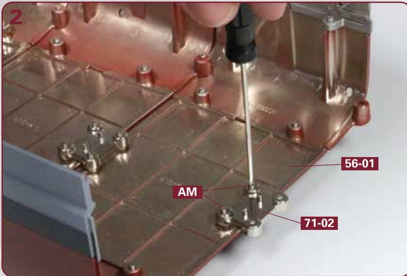
Befestigen Sie das Verbindungsstück **71-02** mit den zwei Schrauben **AM** am Kielabschnitt **56-01**, wie abgebildet.
