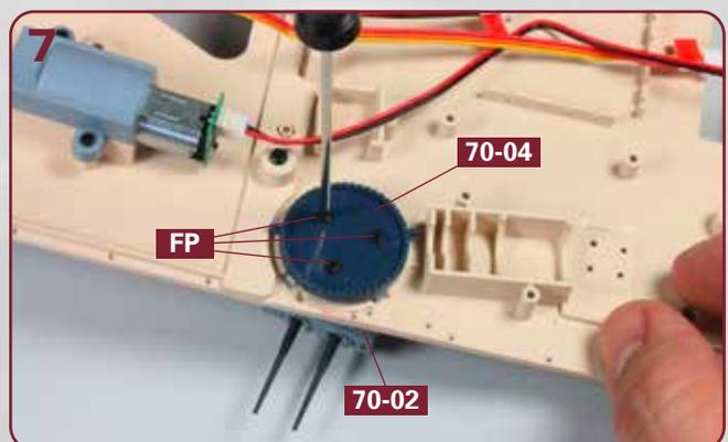
Halten Sie den MA-Turm in Position und drehen Sie das Oberdeck um. Setzen Sie das Zahnrad **70-04** auf die Grundplatte **70-02** und befestigen Sie es mit drei Schrauben **FP**.
