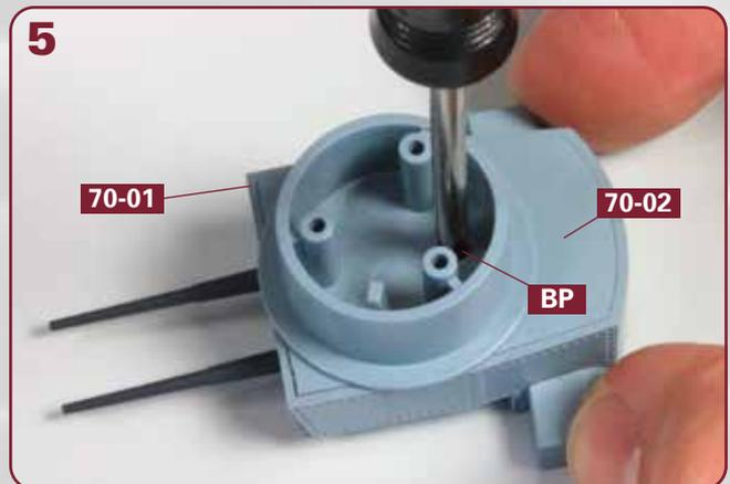
Fixieren Sie die Grundplatte **70-02** mit der Schraube **BP** am MA-Turm **70-01**, wie abgebildet.
