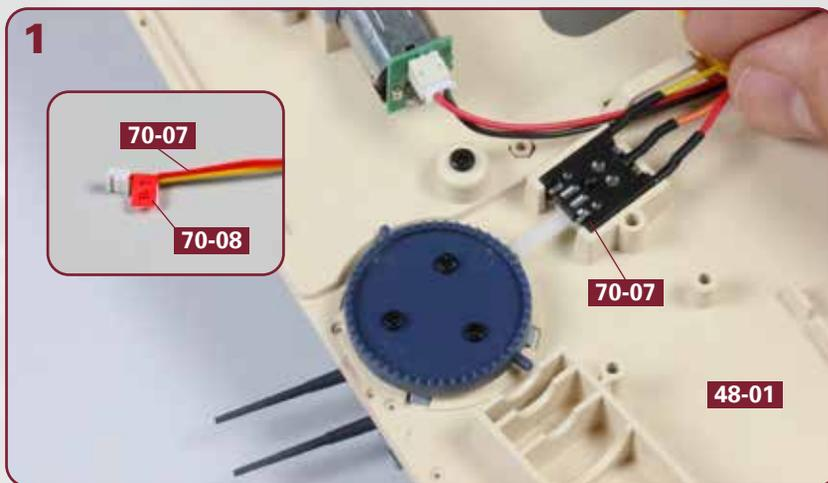
Kleben Sie die Kabelmarkierung **70-08** am Kabel des Endschalters **70-07** fest, wie es das Detailbild zeigt. Nehmen Sie den Endschalter **70-07** und platzieren Sie ihn in der Aussparung an der Unterseite des Oberdecks **48-01**.
