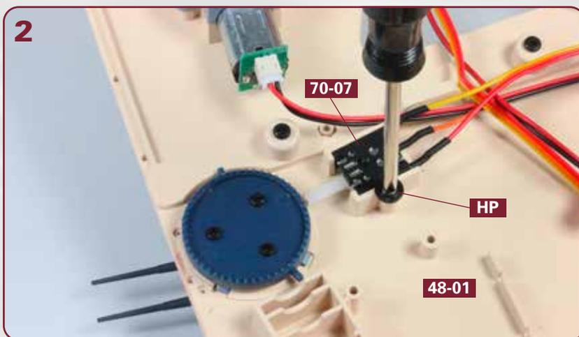
Fixieren Sie den Endschalter **70-07** mit einer Schraube **HP** an der Unterseite des Oberdecks **48-01**.
