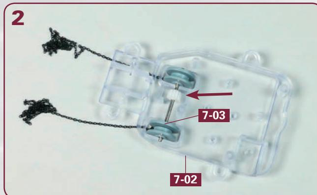
Setzen Sie die Längswelle **7-03** in das Getriebegehäuse-Oberteil **7-02** ein. Achten Sie unbedingt darauf, dass sich das Zahnrad an der Stelle befindet, die das Foto zeigt (siehe Pfeil).
