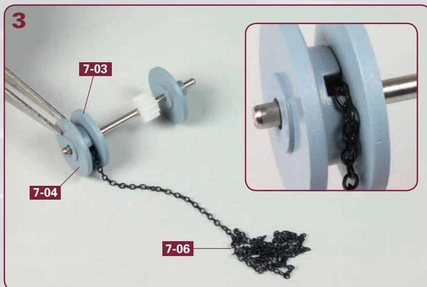
Nehmen Sie den ersten Ankerketten-Aufroller **7-04** und setzen Sie ihn von außen auf die Nabe von dem Querwellen-Rad **7-03**, auf der Sie zuvor schon den Ring der Ankerkette **7-06** platziert haben. Achten Sie unbedingt darauf, dass die Ankerkette direkt aus der Öffnung herauskommt und sich nicht im Inneren der von **7-03** und **7-04** gebildeten „Trommel“ verheddert (siehe Detailbild).
