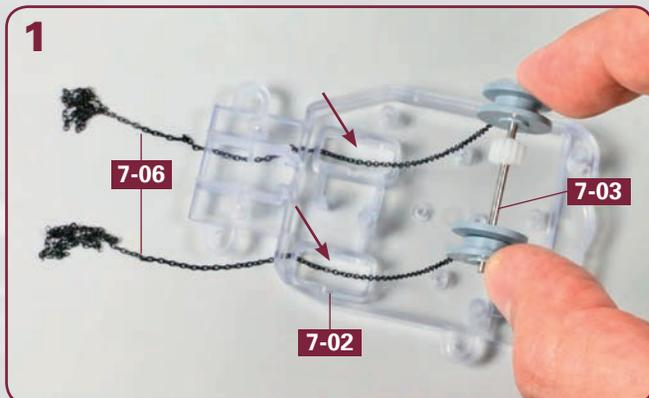
Legen Sie das Getriebegehäuse-Oberteil **7-02** auf Ihre Arbeitsplatte. Führen Sie die Enden der Ankerketten **7-06** durch die beiden großen Öffnungen im Getriebegehäuse, auf die die Pfeile weisen.
