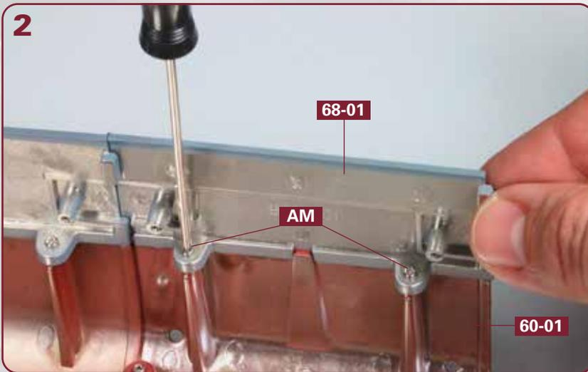
Befestigen Sie den rechten oberen Rumpfabschnitt **68-01** mit zwei Schrauben **AM** am Rumpfabschnitt **60-01**, wie es das Foto zeigt.
