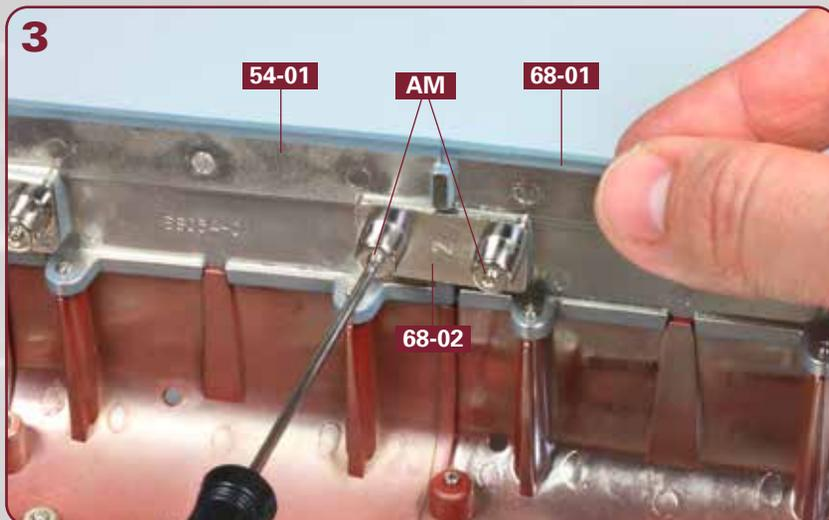
Setzen Sie das Verbindungsstück **68-02** auf die Zapfen der rechten oberen Rumpfabschnitte **68-01** und **54-01**. Befestigen Sie das Verbindungsstück mit zwei Schrauben **AM** an den beiden Rumpfabschnitten, wie es das Foto zeigt.
