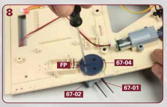
Halten Sie den MA-Turm **67-01** in Position und drehen Sie das Oberdeck um. Setzen Sie das Zahnrad **67-04** auf die Grundplatte **67-02** und befestigen Sie es mit den drei Schrauben **FP**.
