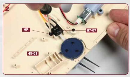
Fixieren Sie den Endschalter 67-07 mit einer Schraube HP an der Unterseite des Oberdecks 48-01.
