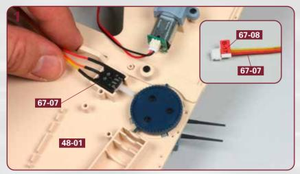
Kleben Sie die Kabelmarkierung **67-08** am Kabel des Endschalters **67-07** fest, wie es das Detailbild zeigt. Nehmen Sie den Endschalter **67-07** und platzieren Sie ihn in der Aussparung an der Unterseite des Oberdecks **48-01**.
