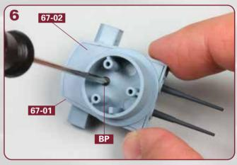
Fixieren Sie die Grundplatte **67-02** mit der Schraube **BP** am umgedrehten MA-Turm **67-01**.
