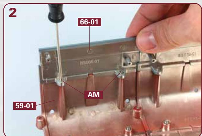
Befestigen Sie den linken oberen Rumpfabschnitt **66-01** mit zwei Schrauben **AM** am Rumpfabschnitt **59-01**, wie es das Foto zeigt.
