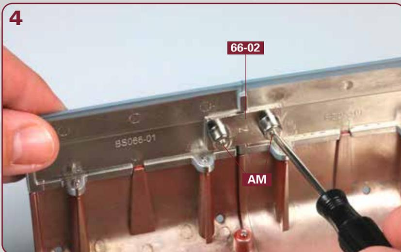
Befestigen Sie das Verbindungsstück **66-02** mit zwei Schrauben **AM** an den beiden Rumpfabschnitten, wie es das Foto zeigt.
