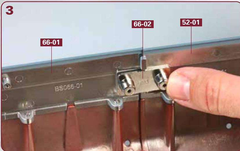
Setzen Sie das Verbindungsstück **66-02** auf die Zapfen der linken oberen Rumpfabschnitte **66-01** und **52-01**.
