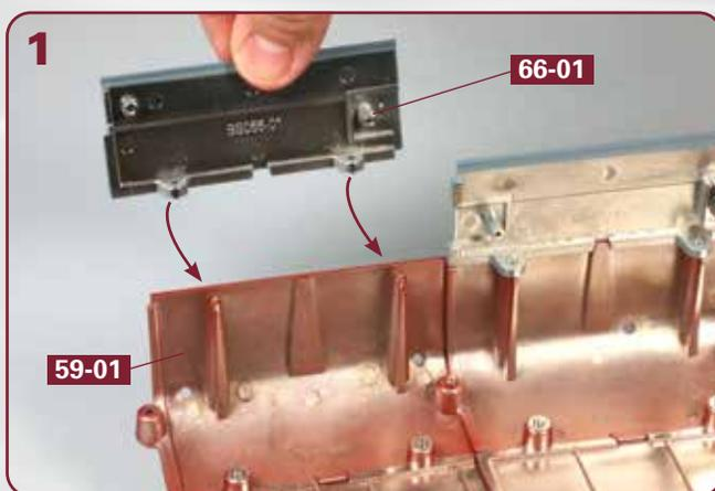
Stellen Sie die Rumpfstruktur auf Ihre Arbeitsplatte. Führen Sie den linken oberen Rumpfabschnitt **66-01** zum linken unteren Rumpfabschnitt **59-01**, wie es die Pfeile andeuten.
