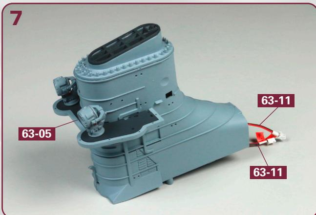
Ziehen Sie solange vorsichtig an den beiden Kabeln **63-11**, bis der zentrale Zapfen der Plattform **63-05** im Schlitz des Schornsteins verschwindet und die Plattform plan am Schornstein anliegt.
