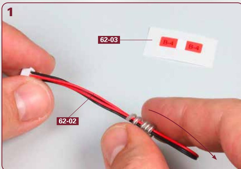
Nehmen Sie das Kabel für den Schwenkmotor **62-02** und entfernen Sie den darum gewickelten Draht, wie angedeutet. Legen Sie die Kabelmarkierung **62-03** bereit.
