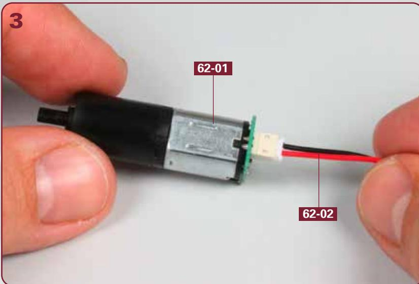
Fügen Sie den (nicht markierten) Stecker vom Kabel **62-02** in den Platinenport des Schwenkmotors **62-01** ein, wie abgebildet.
