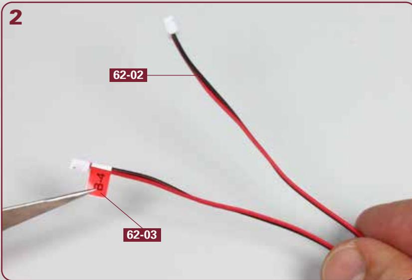
Bringen Sie die Kabelmarkierung **62-03** am Kabel **62-02** an. Achten Sie darauf, dass sich die Markierung an dem Kabelende befindet, das nicht mit dem Motor verbunden wird (siehe nächster Bauschritt).
