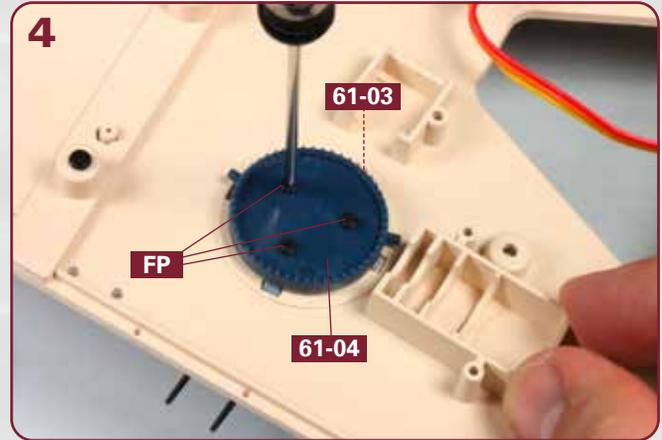
Halten Sie den MA-Turm in Position und drehen Sie das Oberdeck um. Setzen Sie das Zahnrad **61-04** auf die Grundplatte **61-03** und befestigen Sie es mit drei Schrauben **FP**.
