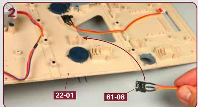
Nehmen Sie den Endschalter **61-08** und führen Sie ihn zur Ausparung an der Unterseite des Oberdeckes **22-01**, wie angedeutet.
