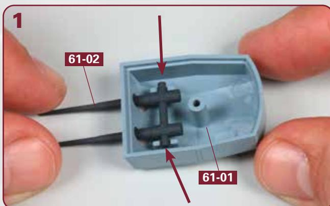
Setzen Sie die Rohre **61-02** so in den umgedrehten MA-Turm **61-01** ein, dass die Zapfen der Wiege in den Aussparungen des Turms ruhen (Pfeile).
