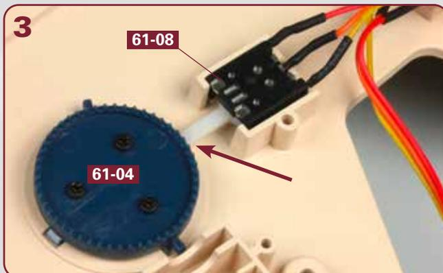
Der Endschalter **61-08** wird so in die Ausparung des Oberdeckes eingefügt, dass er Kontakt zum Zahnrad **61-04** aufweist (Pfeil).
