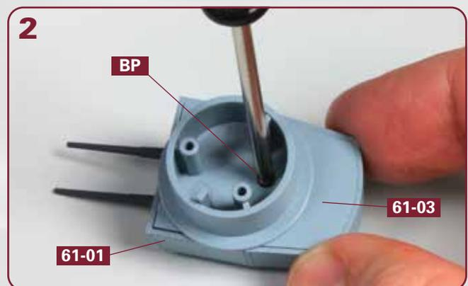
Setzen Sie die Grundplatte **61-03** auf die Unterseite des umgedrehten MA-Turms **61-01** und fixieren Sie sie mit einer Schraube **BP**.
