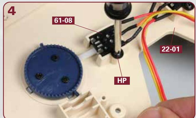
Der Endschalter **61-08** wird mit einer Schraube **HP** an der Unterseite des Oberdeckes **22-01** fixiert.
