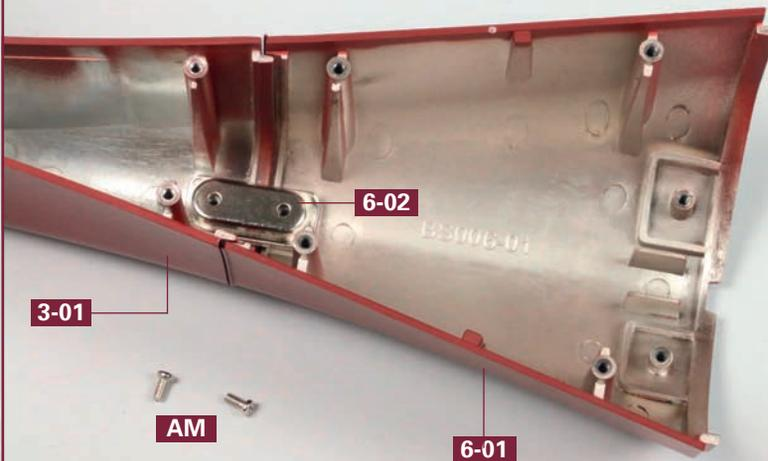
An der Verbindungsstelle der beiden Rumpfabschnitte **3-01** und **6-01** setzen Sie das Verbindungsstück **6-02** auf, wie abgebildet. Legen Sie zwei Schrauben **AM** bereit.
