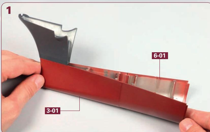
Nehmen Sie die Bug-Sektion des Rumpfs hervor, die Sie zuletzt mit der Bauanleitung der Ausgabe 3 bearbeitet haben. Fügen Sie das Unterteil des Bugs **3-01** und den diesmal gelieferten zweiten Kielabschnitt **6-01** zusammen, wie es das Foto zeigt.
