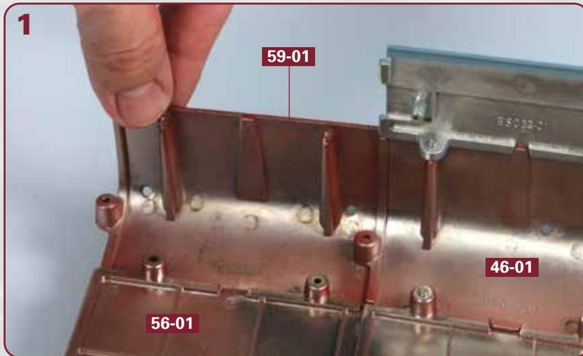
Stellen Sie die Rumpfstruktur so auf Ihre Arbeitsplatte, dass Sie Zugriff auf die linke Rumpfseite haben. Nehmen Sie den linken unteren Rumpfabschnitt **59-01** und fügen Sie seine Zapfen in die Aufnahmen des Kielabschnitts **56-01** und des Rumpfabschnitts **46-01** ein, wie abgebildet.
