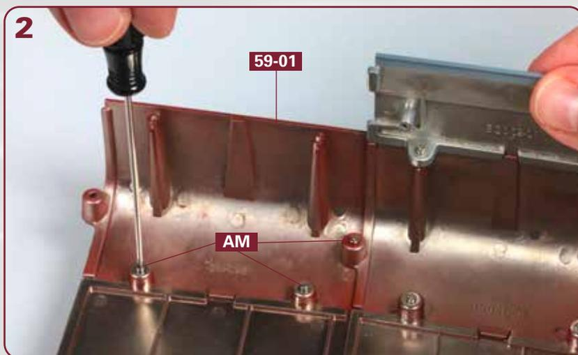
Befestigen Sie den linken unteren Rumpfabschnitt **59-01** mit drei Schrauben **AM** an der Rumpfstruktur, wie es das Foto zeigt.
