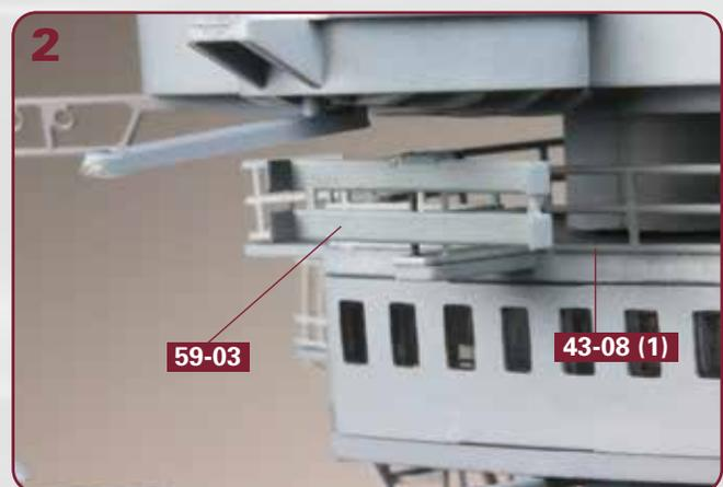
2 Der Rahmen **59-03** wird an der kleinen mittigen Ausbuchtung der Reling **43-08 (1)** am unteren Scheinwerferdeck festgeklebt.
