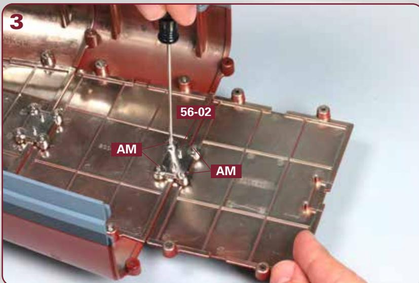
Befestigen Sie das Verbindungsstück **56-02** mit vier Schrauben **AM** an den beiden Kielabschnitten, wie abgebildet.
