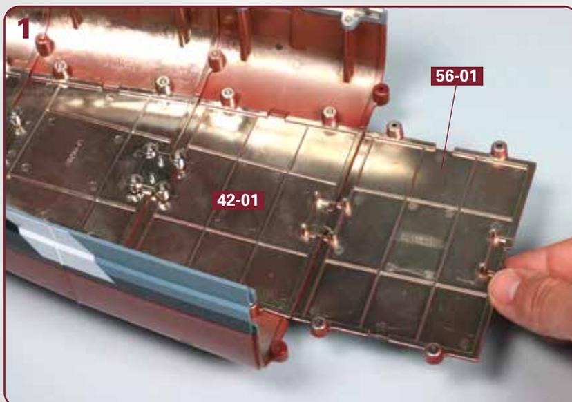
Stellen Sie die Rumpfstruktur so auf Ihre Arbeitsplatte, dass Sie Zugriff auf den hinteren Bereich der Struktur haben. Führen Sie den siebten Kielabschnitt **56-01** an den sechsten Kielabschnitt **42-01** heran: Die beiden Abschnitte müssen auf ganzer Länge plan aneinander liegen, wie es das Foto zeigt.
