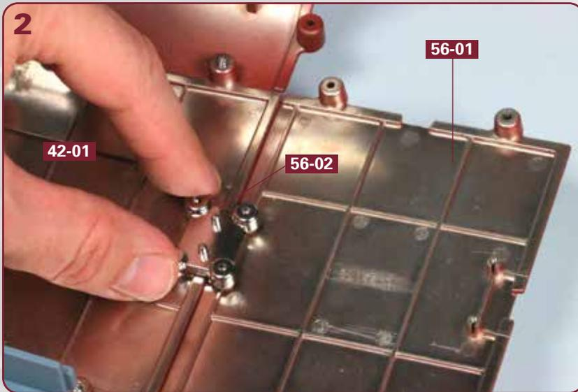
Setzen Sie das Verbindungsstück **56-02** auf die vier Zapfen der Kielabschnitte **42-01** und **56-01**.
