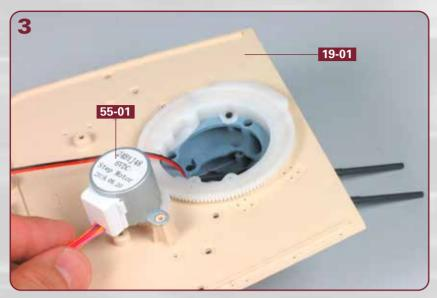
Legen Sie die zuletzt mit der 53. Bauanleitung bearbeitete Oberdecksstruktur 19-01/22-01/48-01 verkehrt herum auf Ihre Arbeitsfläche. Setzen Sie den Schrittmotor 55-01 so an der Unterseite vom Decksteil 19-01 auf, dass seine beiden Bohrungen sich über den beiden großen Zapfen des Decksteils befinden.
