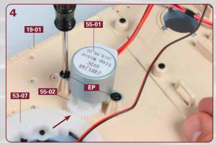
Ist der Schrittmotor korrekt aufgesetzt, greifen die Zahnräder **55-02** und **53-07** ineinander (Pfeil). Befestigen Sie den Schrittmotor **55-01** mit zwei Schrauben **EP** am Decksteil **19-01**.
