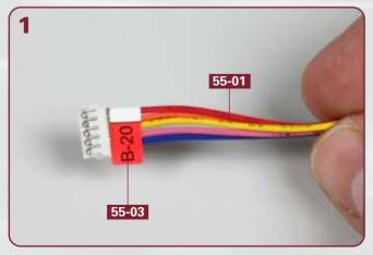
Befestigen Sie die Kabelmarkierung **55-03** am Kabelende des Schrittmotors **55-01**, wie es das Foto zeigt.
