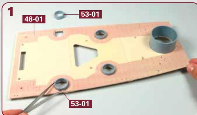
Legen Sie die Oberdeckstruktur **19-01/22-01/48-01** auf Ihre Arbeitsplatte. Nehmen Sie die beiden MA-Barbetten **53-01** und fügen Sie die erste in die entsprechende Öffnung von **48-01** ein.
