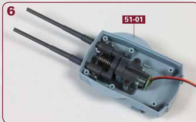
Stellen Sie die Drehhaube **51-01** kopfüber auf Ihre Arbeitsplatte. Setzen Sie die Geschützrohr-Baugruppe in die Drehhaube ein, wie abgebildet.
