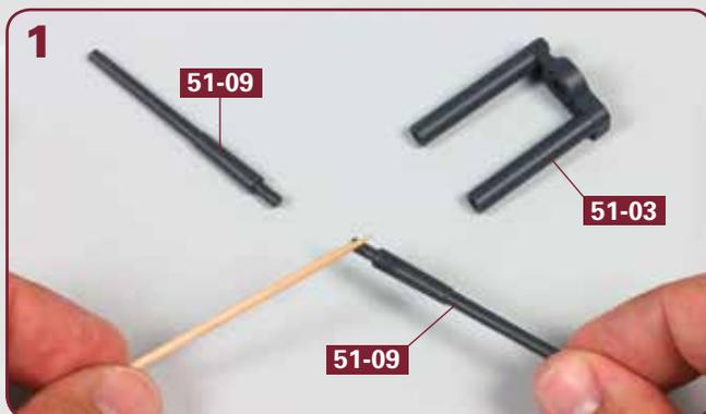
Legen Sie das Verbindungsstück **51-03** und die beiden Rohre **51-09** auf Ihre Arbeitsplatte. Versehen Sie das Ende des einen Rohrs mit etwas Sekundenkleber, wie angedeutet.
