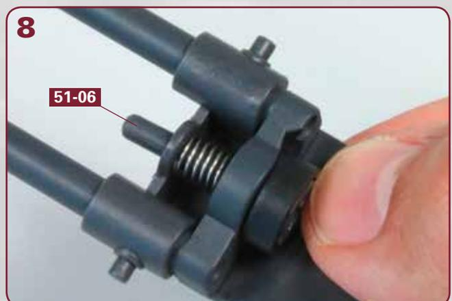
Führen Sie den Schaft der Kupplungswelle **51-06** durch die Bohrung des Verbindungsstücks, die Spannfeder und die Bohrung der Rohrwiege.
