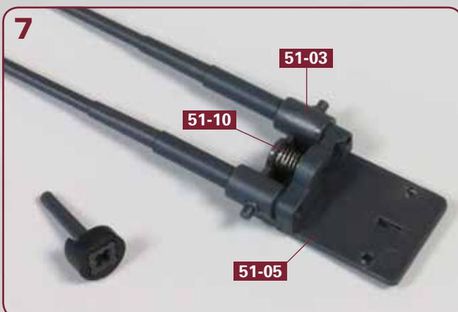
Die Spannfeder **51-10** wird mittig zwischen dem Verbindungsstück **51-03** und der Rohrwiege **51-05** eingefügt.
