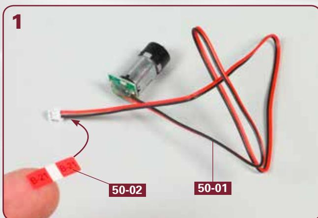
Legen Sie den Kadenzmotor **50-01** auf Ihre Arbeitsplatte. Lösen Sie die Kabelmarkierung **50-02** von der Trägerfolie und führen Sie sie zum Kabelende des Motors, wie angedeutet.
