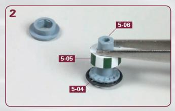
Kleben Sie den Spillkopf **5-04** in der Bohrung der Spillwelle **5-06** fest. Drehen Sie die Spillwelle um und drücken Sie den grünen Spillkörper **5-05** vorsichtig den Wellenschaft hinunter, wie abgebildet.
