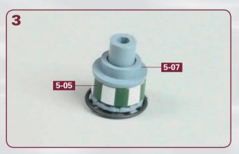
Drücken Sie den grünen Spillkörper **5-05** am Wellenschaft bis zum Anschlag hinunter. Anschließend verfahren Sie genauso mit dem Spillkörper-Unterteil **5-07**. Das Foto zeigt das fertige Spill.
