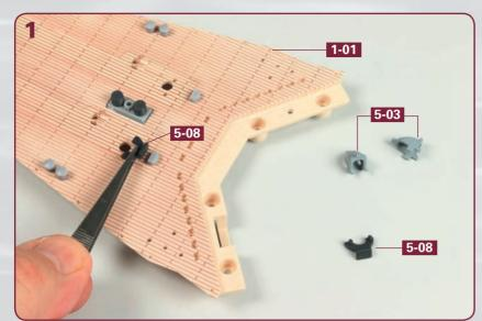
Legen Sie das Vorderteil des Oberdecks 1-01, die beiden Schutzhauben der Ankerketteneinläufe 5-03 und die beiden Kettenbegrenzer 5-08 auf Ihre Arbeitsfläche. Positionieren Sie den ersten Kettenbegrenzer testweise an der abgebildeten Stelle des Oberdecks.
