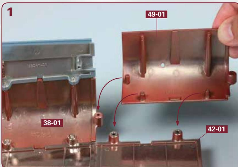
Stellen Sie die Rumpfstruktur auf Ihre Arbeitsplatte. Nehmen Sie den rechten unteren Rumpfabschnitt **49-01** und führen Sie ihn zur rechten Seite des sechsten Kielabschnitts **42-01**, wie angedeutet. Die Zapfen des Rumpfabschnitts **49-01** werden von unten in die entsprechenden Bohrungen des Kielabschnitts und des Rumpfabschnitts **38-01** eingefügt.
