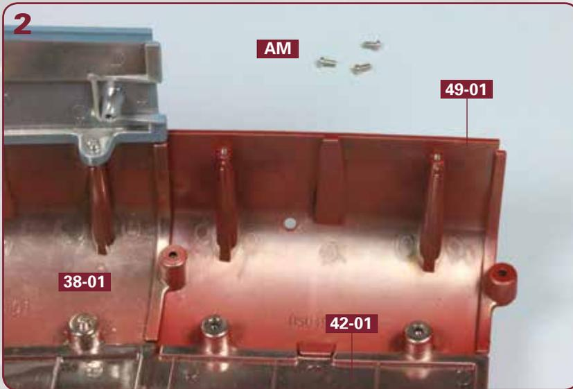
Die drei Zapfen des rechten unteren Rumpfabschnitts **49-01** sind in die Bohrungen des Kielabschnitts **42-01** und des Rumpfabschnitts **38-01** eingefügt. Legen Sie drei Schrauben **AM** bereit.
