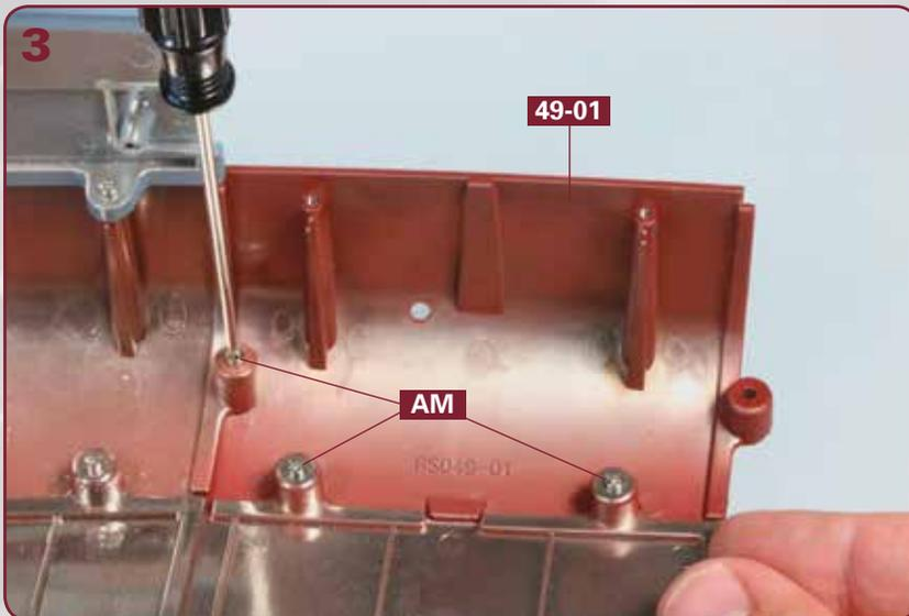
Fixieren Sie den linken unteren Rumpfabschnitt **49-01** an der Rumpfstruktur, indem Sie drei Schrauben **AM** festziehen.
