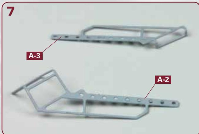
Trennen Sie die beiden Handläufe **A-2** und **A-3** aus dem Rahmen **47-08**. Biegen Sie die Relings an deren oberen Enden so, wie es das Foto zeigt.
