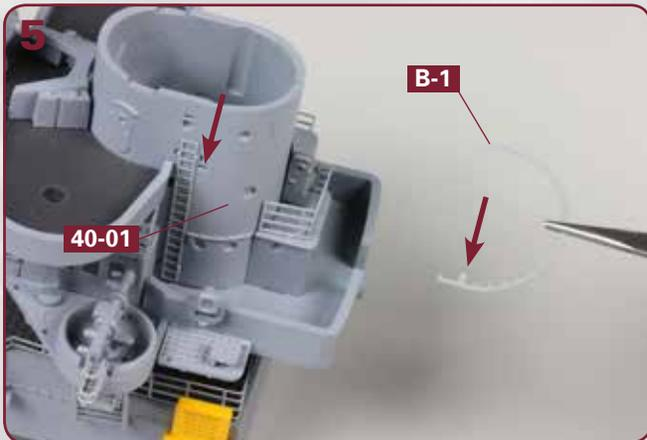
Trennen Sie den Halbring **B-1** aus dem Rahmen **47-09**. Der große Zapfen von **B-1** (rechter Pfeil) gehört in die Vertiefung am Gefechtsmast **40-01**, auf die der linke Pfeil weist.
