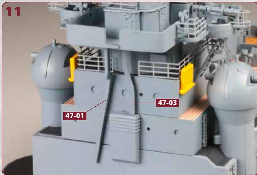
Unweit vom linken Rohr **47-01** kleben Sie das kurze mittlere Rohr **47-03** fest. Ebenso wie bei den anderen Rohren fügen Sie dazu die beiden Zapfen in die entsprechenden Bohrungen an der Rückseite der vorderen Aufbauten ein.
