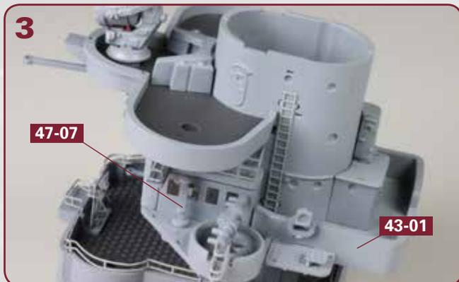
Der erste der vier Peilkompass **47-07** wird auf der Backbordseite der Admiralsbrücke **43-01** festgeklebt, wie es das Foto zeigt.
