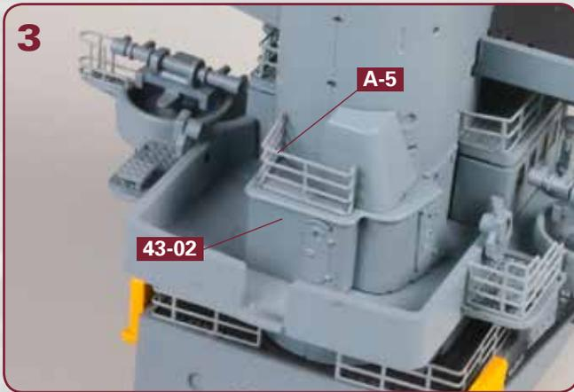
Die Reling **A-5** wird auf dem Schutzstand **43-02** an der Rückseite des Gefechtmastes festgeklebt.
