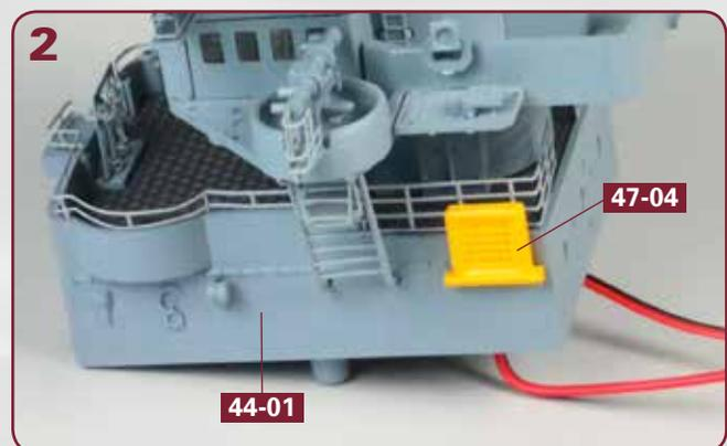
Das zweite Rettungsfloß **47-04** wird an der gleichen Stelle auf der Backbordseite des unteren Mastdecks **44-01** festgeklebt, wie abgebildet.
