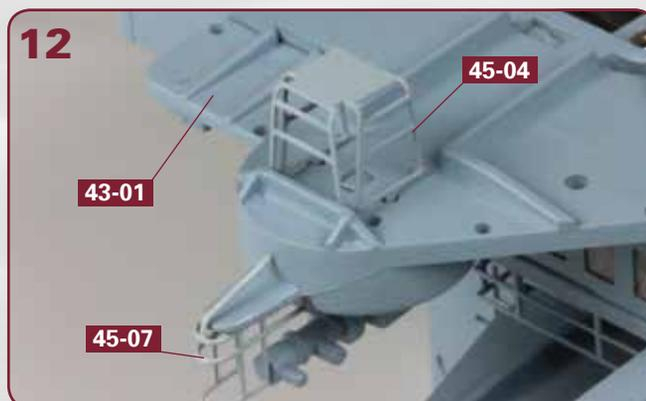
Am anderen Ende der Unterseite von der Admiralsbrücke **43-01** wird die zweite Plattform **45-04** festgeklebt.
