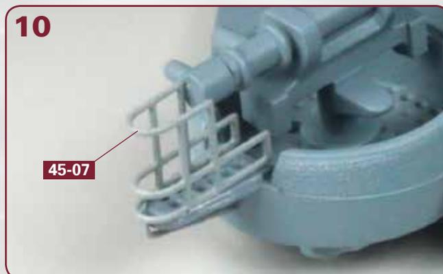
An der gleichen Stelle wird auf der Backbordseite der Admiralsbrücke die zweite Reling **45-07** festgeklebt.
