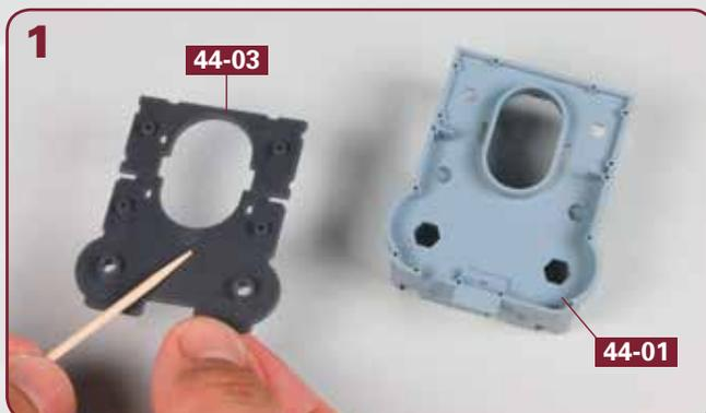
Stellen Sie das obere Mastdeck **44-01** auf Ihre Arbeitsplatte. Nehmen Sie den Decksbelag **44-03** und versehen Sie dessen Unterseite mit etwas Sekundenkleber, wie angedeutet.
