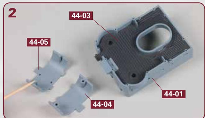
Kleben Sie den Decksbelag **44-03** auf dem Mastdeck **44-01** fest. Legen Sie die beiden Abschnitte des Gefechtmastes **44-04** und **44-05** bereit und versehen Sie deren Kontaktstellen mit Klebstoff.
