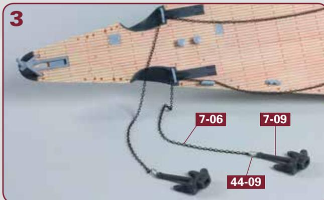
Der zweite neue Ankerring **44-09** wird ebenfalls mit einer Ankerkette **7-06** und einem Ankerschaft **7-09** verbunden, wie es das Foto zeigt.
