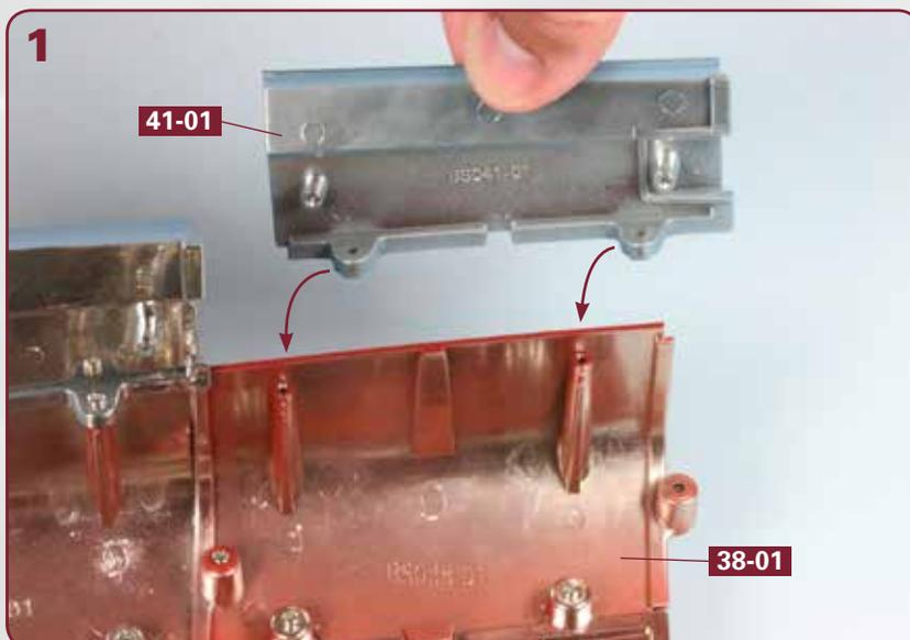
Stellen Sie die Rumpfstruktur auf Ihre Arbeitsplatte. Nehmen Sie den rechten oberen Rumpfabschnitt **41-01** und setzen Sie ihn auf den rechten unteren Rumpfabschnitt **38-01**, wie angedeutet.
