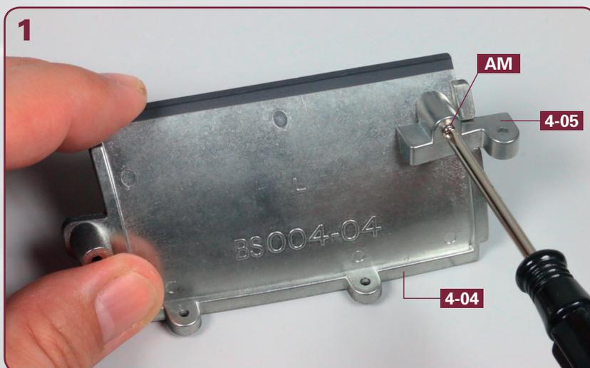
Nehmen Sie das Verbindungsstück **4-05** und setzen Sie es über dem Zapfen des Rumpfabschnitts **4-04** auf. Befestigen Sie beide Teile mit einer Schraube **AM** aneinander.
