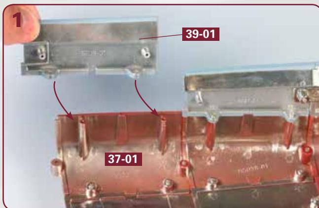
Stellen Sie die Rumpfstruktur auf Ihre Arbeitsplatte. Fügen Sie die Zapfen des linken oberen Rumpfabschnitts **39-01** in die Bohrungen des Rumpfabschnitts **37-01** ein.
