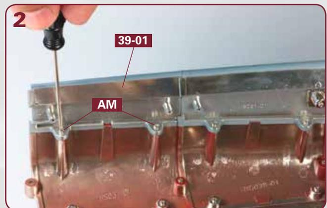
Befestigen Sie den Rumpfabschnitt **39-01** mit zwei Schrauben **AM** an der Rumpfstruktur, wie es das Foto zeigt.
