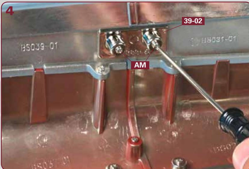
Befestigen Sie das Verbindungsstück **39-02** mit zwei Schrauben **AM** an der Rumpfstruktur.
