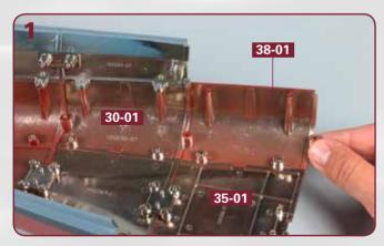
Stellen Sie die Rumpfstruktur auf Ihre Arbeitsplatte. Fügen Sie die Zapfen des rechten unteren Rumpfabschnitts **38-01** in die Bohrungen der Rumpfabschnitte **30-01** und **35-01** ein.
