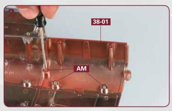
Befestigen Sie den Rumpfabschnitt **38-01** mit drei Schrauben **AM** an der Rumpfstruktur.
