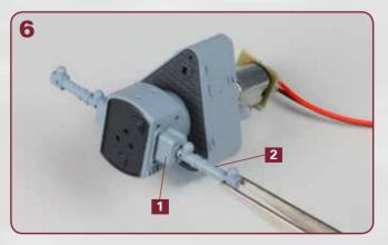
Das zweite Teil 2 wird am zweiten E-Mess-Fundament 1 festgeklebt. Achten Sie auch hier wieder auf die Ausrichtung der Zapfen, wie abgebildet.
