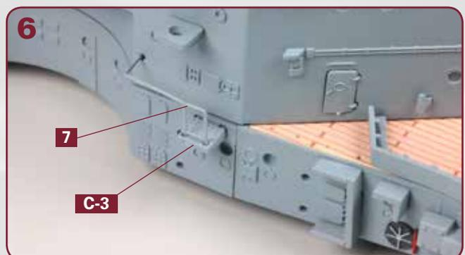
6 Auf der anderen Seite des Aufbaudecks wird an gleicher Stelle die Reling **7** an der Plattform **C-3** festgeklebt.
