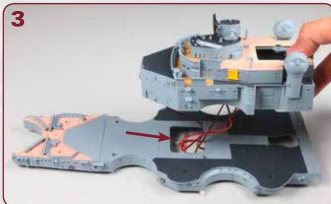
3 Legen Sie das Aufbaudeck auf Ihre Arbeitsplatte. Führen Sie die Brücken-Mastdeck-Baugruppe so heran, dass alle Kabel in der großen Aussparung des Aufbaudecks verschwinden (Pfeil).
