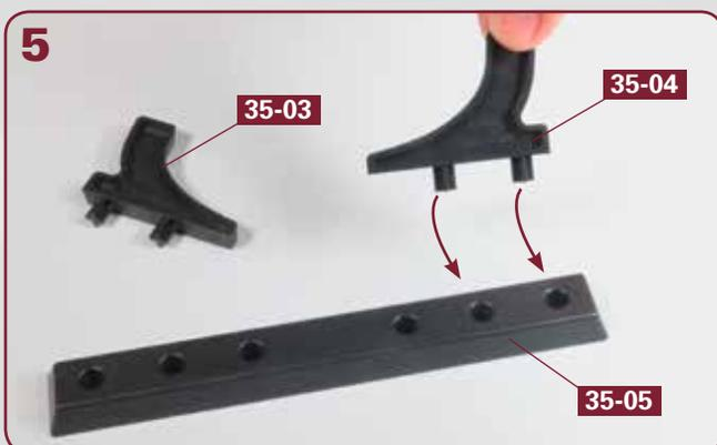
Legen Sie den Träger **35-05** sowie die Halterungen **35-03** und **35-04** auf Ihre Arbeitsplatte. Führen Sie die rechte Halterung **35-04** zu den entsprechenden Bohrungen des Trägers, wie angedeutet.
