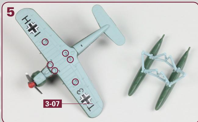
Geben Sie etwas Sekundenkleber in die sechs auf dem Foto umkreisten Vertiefungen an der Unterseite der Tragflächen **3-07**. Dort werden die sechs Spitzen der Schwimmer-Verstrebungen eingefügt.
