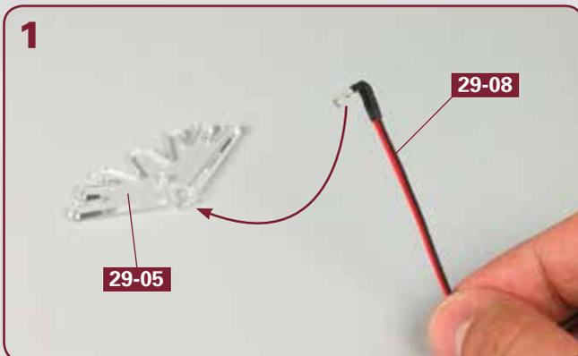
Legen Sie die Brückenfenster **29-05** auf Ihre Arbeitsplatte. Nehmen Sie das LED-Kabel **29-08** und führen Sie die LED zur Aussparung von **29-05**.
