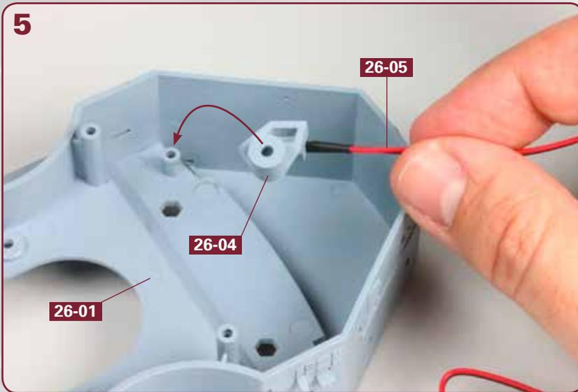
Stellen Sie das Brückendeck **26-01** vorsichtig auf den Kopf. Vorne auf der rechten Seite der Struktur setzen Sie die Halterung **26-04** auf den Zapfen, wie es der Pfeil andeutet.
