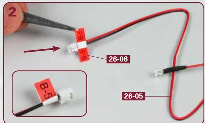
Bringen Sie die Kabelmarkierung **26-06** an dem Kabelende mit dem Stecker (Pfeil) an und kleben Sie die beiden Enden der Kabelmarkierung zusammen (siehe Detailfoto).
