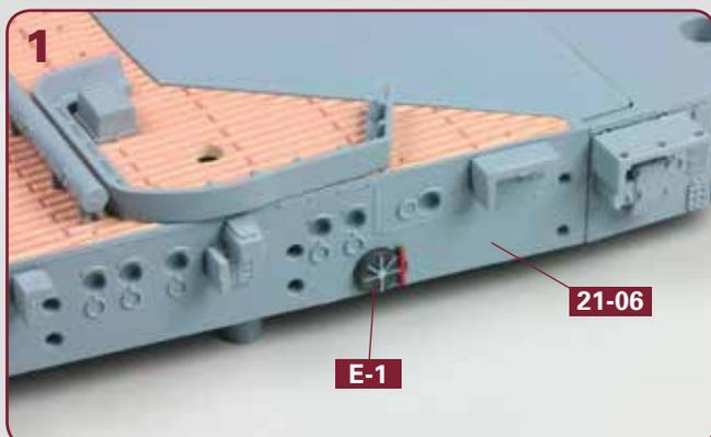
Nehmen Sie die große Struktur des Aufbaudecks hervor. Vorne auf der linken Seite (an Teil **21-06**) wird der Feuerlöschschlauch **E-1** festgeklebt.
