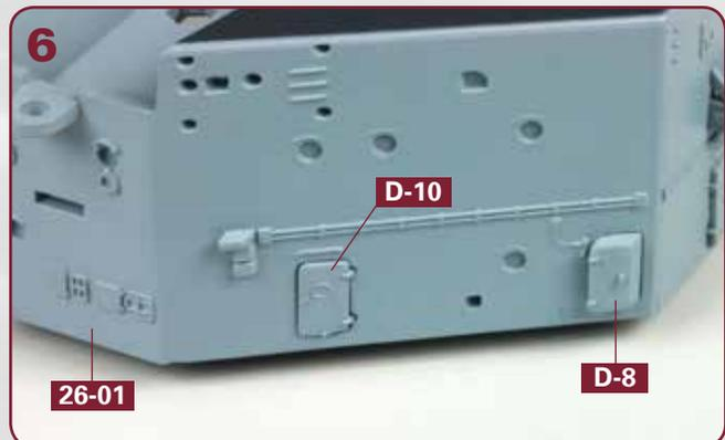
In der rechten vorderen Schräge des Brückendecks **26-01** kleben Sie den Schrank **D-8** und die Tür **D-10** fest.
