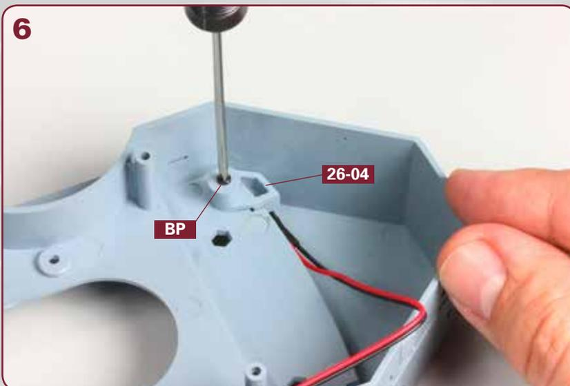
Befestigen Sie die aufgesetzte Halterung **26-04** mit einer Schraube **BP** am Brückendeck, wie abgebildet.
