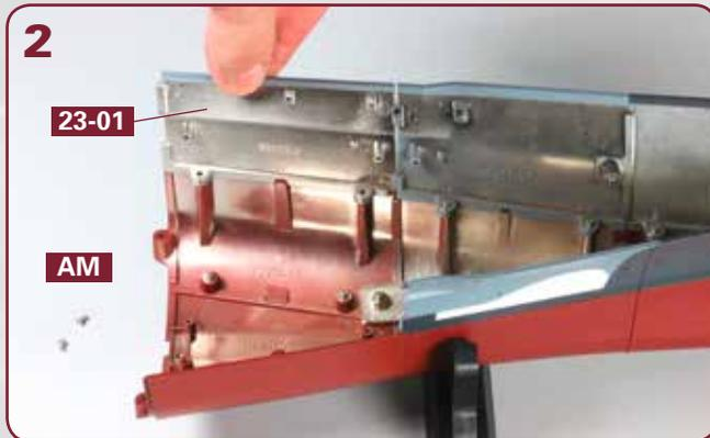
Der Rumpfabschnitt **23-01** ist an der Rumpfstruktur aufgesetzt. Legen Sie zwei Schrauben **AM** bereit.
