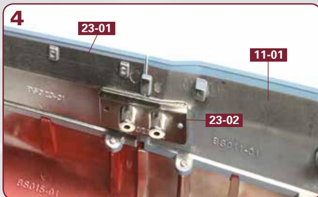
Setzen Sie das Verbindungsstück **23-02** auf die Zapfen der Rumpfabschnitte **23-01** und **11-01**.
