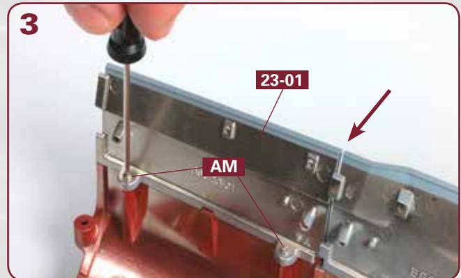
Fixieren Sie den Rumpfabschnitt **23-01** mit den zwei Schrauben **AM** an der Rumpfstruktur. Der Spalt, auf den der Pfeil weist, verschwindet später.
