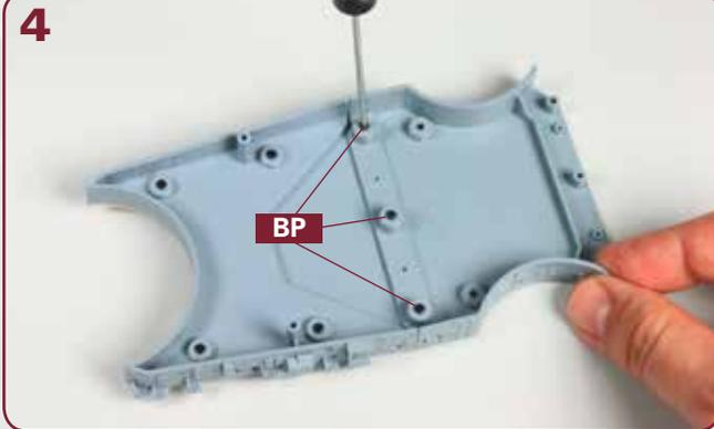
Fixieren Sie die beiden Strukturen des Aufbaudecks aneinander, indem Sie die drei Schrauben **BP** in die gemeinsamen Bohrungen eindrehen.
