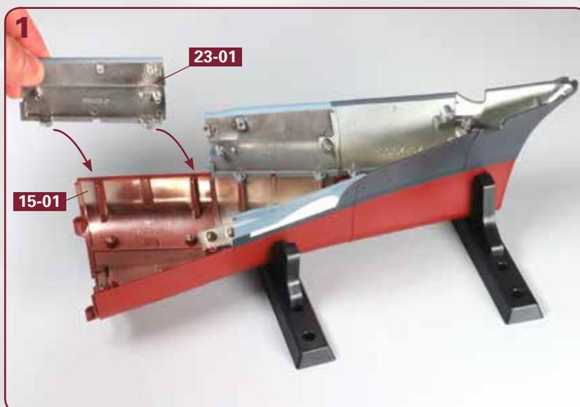
Stellen Sie die Rumpfstruktur auf Ihre Arbeitsplatte. Nehmen Sie den linken oberen Rumpfabschnitt **23-01** und setzen Sie ihn auf den linken unteren Rumpfabschnitt **15-01**, wie es die Pfeile andeuten.
