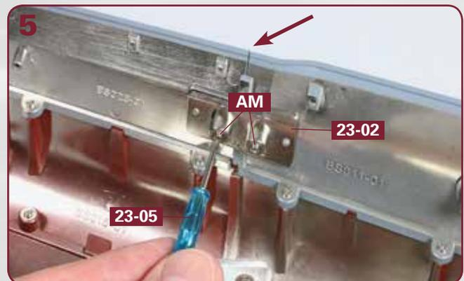
In den Bohrungen des Verbindungsstücks **23-02** ziehen Sie zwei Schrauben **AM** mit dem kleinen Schraubendreher **23-05** fest. Der Spalt zwischen den Rumpfabschnitten verschwindet dadurch.
