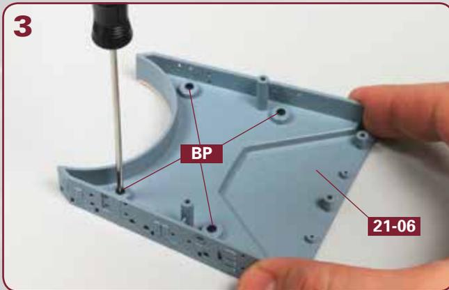
Drehen Sie die Struktur **21-06** auf den Kopf und halten Sie dabei das Deck in Position. Fixieren Sie das Deck an der Struktur, indem Sie die vier Schrauben **BP** festziehen.
