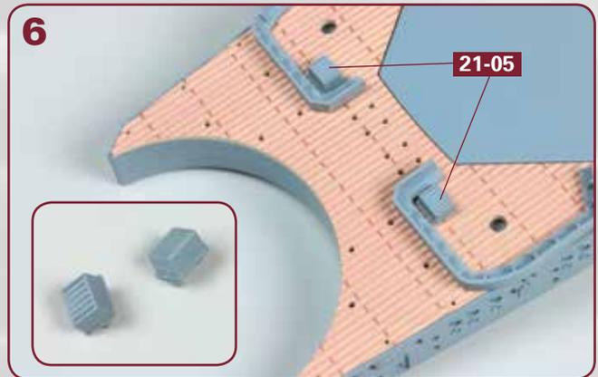
Trennen Sie die beiden Oberlichter **21-05** aus dem Rahmen heraus und glätten Sie die Verbindungsstellen an den Teilen (siehe Detailfoto). Kleben Sie die Oberlichter auf dem Aufbaudeck fest.
