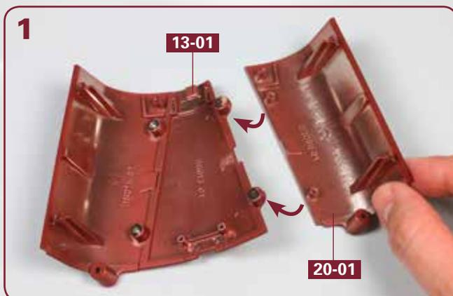
Legen Sie die Rumpfbaugruppe **13-01/15-01** auf Ihre Arbeitsplatte. Nehmen Sie den Rumpfabschnitt **20-01** und führen Sie seine beiden Zapfen zu den Bohrungen von **13-01**, wie angedeutet.
