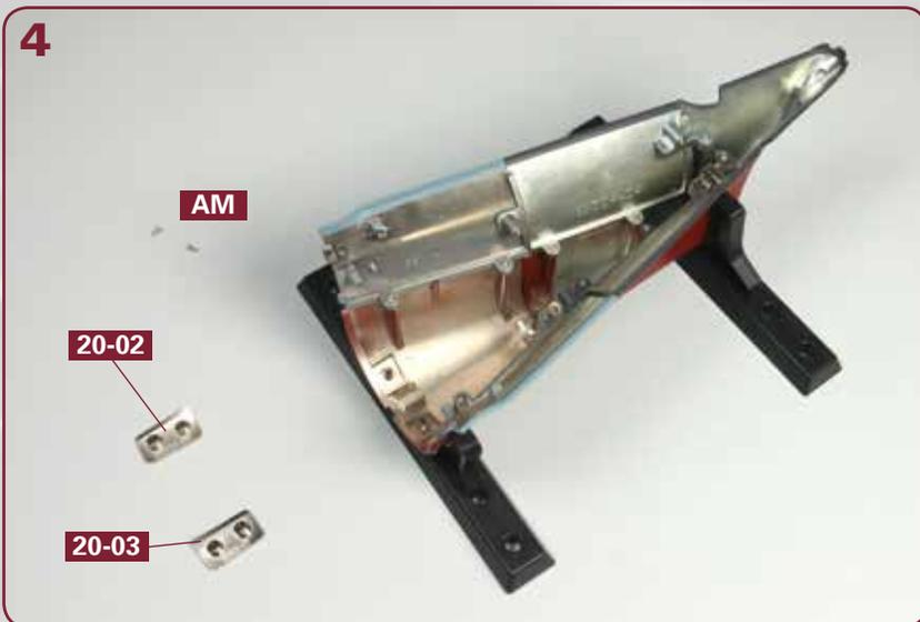
Stellen Sie die große Rumpfbaugruppe, die Sie mit den Ausgaben 3-11 zusammengebaut haben, auf die beiden Halterungen. Legen Sie die beiden Verbindungsstücke **20-02** und **20-03** sowie zwei Schrauben **AM** bereit.
