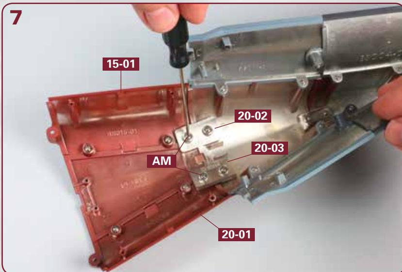
In den hinteren Bohrungen der beiden Verbindungsstücke **20-02** und **20-03** wird jeweils eine Schraube **AM** eingedreht. Sie fixieren die Rumpfabschnitte **15-01** und **20-01**.
