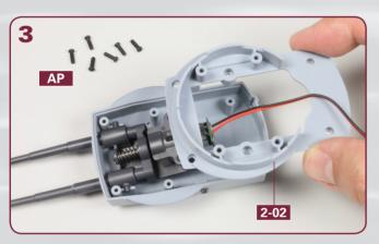
Legen Sie sechs Schrauben **AP** bereit und nehmen Sie die Grundplatte des Geschützturms **2-02**. Richten Sie die Grundplatte so aus, wie es das Foto zeigt, und führen Sie das Motorkabel durch deren große Öffnung.
