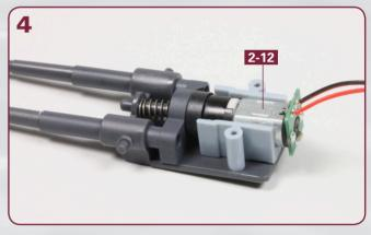
Der korrekt in die Motorhalterung eingesetzte Motor **2-12**: Die Kabel der Platine weisen im Bild nach oben, die Motorwelle ist in die Kupplungswelle eingerückt.
