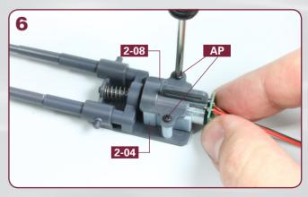
**2-08** mit den zwei Schrauben **AP** am Oberteil der Motorhalterung **2-04**.
