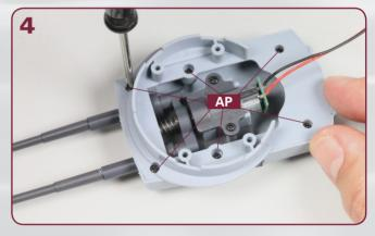
Setzen Sie die Grundplatte auf der Drehhaube auf und befestigen Sie sie mit den sechs Schrauben AP, wie abgebildet.
