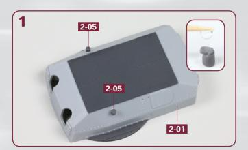
Legen Sie die Drehhaube des Geschützturms 2-01 auf Ihre Arbeitsplatte. Nehmen Sie die beiden Lüfter 2-05 und versehen Sie deren Zapfen mit einem winzigen Tropfen Sekundenkleber (siehe Detailbild). Kleben Sie die beiden Lüfter an den Turmschrägen fest.
