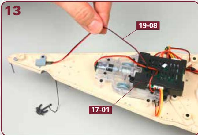
Führen Sie das hintere Ende vom LED-Kabel **19-08** durch die Öse auf der Platinen-Box **17-01**.
