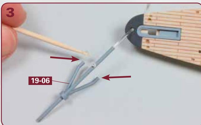
Geben Sie auf die beiden Füße (Pfeile) der Stütze **19-06** etwas Sekundenkleber, wie angedeutet.
