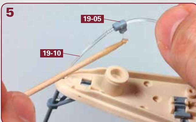
Führen Sie die Halterung **19-05** über das Ende des Lichtleitkabels **19-10**. Geben Sie etwas Klebstoff auf den Zapfen der Halterung.
