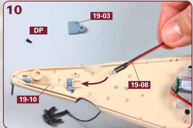
Legen Sie die LED-Abdeckung **19-03** und eine Schraube **DP** bereit. Nehmen Sie das LED-Kabel **19-08** und führen Sie die LED zum hinteren Ende des Lichtleitkabels **19-10**, wie es der Pfeil andeutet.
