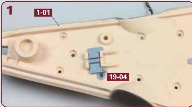
Legen Sie die große Decks-Baugruppe verkehrt herum auf Ihre Arbeitsfläche. Fügen Sie die Führung **19-04** unweit des Bugs zwischen den beiden Erhebungen an der Unterseite des Decks **1-01** ein.
