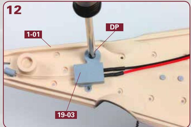
Fixieren Sie die LED-Abdeckung **19-03** mit der Schraube **DP** über der LED am Deck **1-01**.
