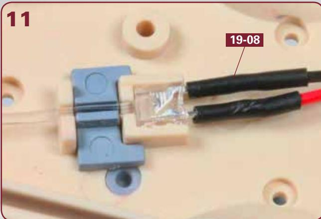
Die LED des LED-Kabels **19-08** ist korrekt eingesetzt und stößt an das Ende des Lichtleitkabels **19-10**.
