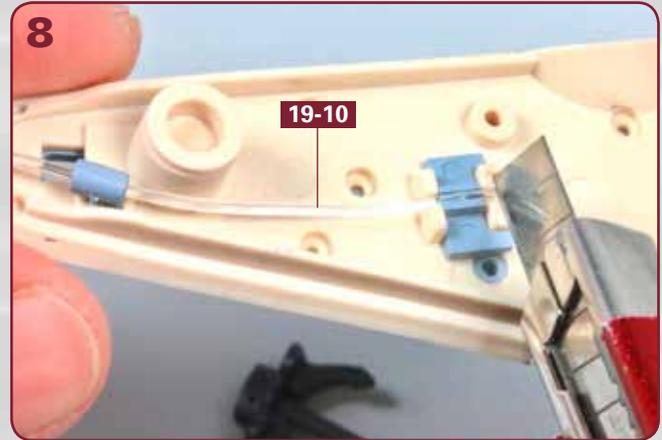
Schneiden Sie das Lichtleitkabel **19-10** exakt an der Hinterkante der hinteren kleinen Erhebung an der Decksunterseite ab (siehe auch nächstes Foto).
