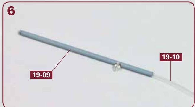
Ziehen Sie das Lichtleitkabel **19-10** so weit durch den Bugflaggenstock **19-09**, dass der Knoten direkt vor dessen Öffnung sitzt. (Der Knoten darf nicht so klein sein, dass er durch die Öffnung rutscht.)
