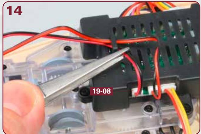
Verbinden Sie den Stecker vom LED-Kabel **19-08** mit dem Port 1 der Platinen-Box, wie abgebildet.
