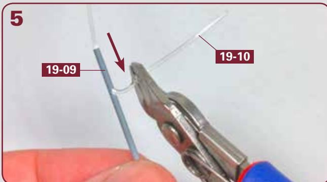
Schneiden Sie das kurze Ende vom Lichtleitkabel **19-10** direkt hinter dem Knoten (Pfeil) ab.
