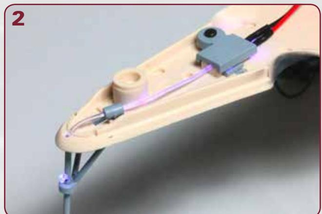
Zur Verdeutlichung: Am umgedrehten Oberdeck ist zu erkennen, wie das Licht von der LED zum Knoten am Flaggenstock geleitet wird.
