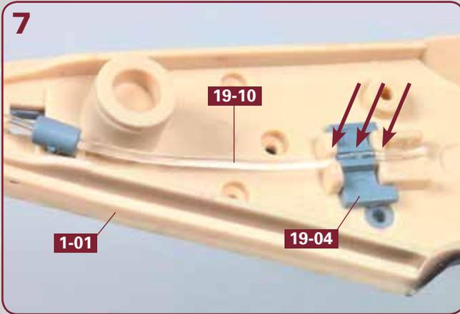
Drücken Sie das Lichtleitkabel **19-10** in die Vertiefungen an der Führung **19-04** und der Unterseite des Decks **1-01** hinein (drei Pfeile).
