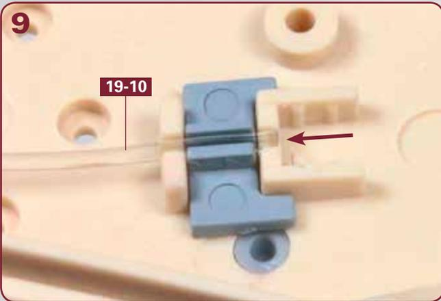
Das Foto zeigt das korrekt gekürzte Lichtleitkabel **19-10** im Detail: Es endet an der Hinterkante der hinteren Erhebung des Decks (Pfeil).
