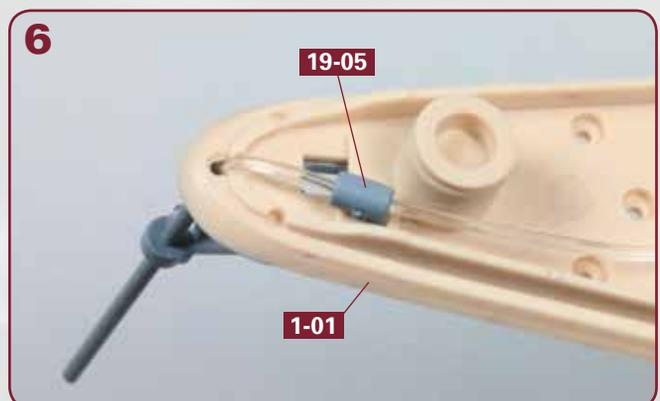
Kleben Sie die Halterung **19-05** in der bugnahen Vertiefung an der Unterseite des Oberdecks **1-01** fest, wie es das Foto zeigt.
