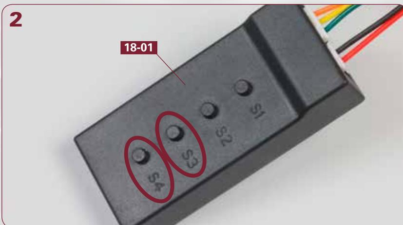
Die Knöpfe „S3“ und „S4“ auf dem Tester **18-01** sind noch ohne Funktion. Mit dem Knopf „S3“ wird das Buglicht getestet, das mit der nächsten Bauanleitung montiert wird.
