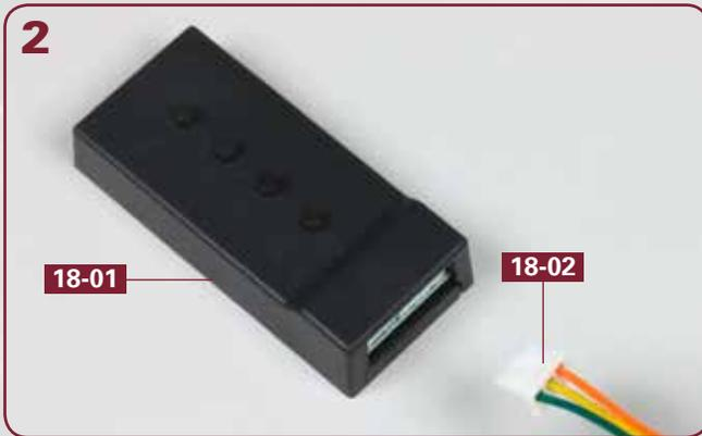
Führen Sie das Tester-Kabel **18-02** zum rechten Port des Testers **18-01**. Die Litzen am Stecker weisen, wie üblich, nach unten.
