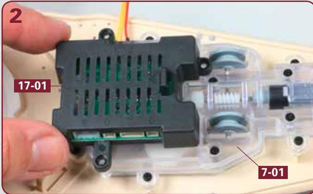
Die Platinen-Box **17-01** ist auf dem Getriebegehäuse-Unterteil **7-01** aufgesetzt. Die Bohrungen beider Teile stimmen überein.
