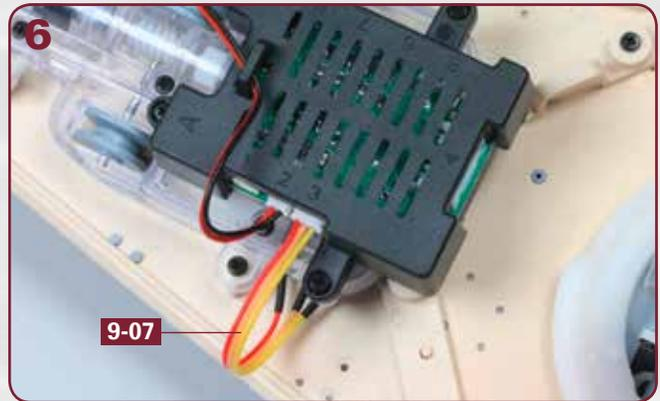
Verbinden Sie den Stecker vom Kabel **9-07** mit dem Port 3 der Platinen-Box, wie abgebildet. Auch hier weisen die Litzen des Steckers wieder nach unten.
