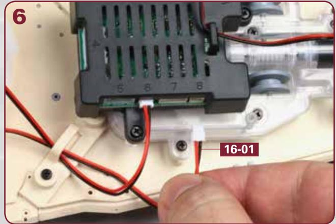
Beim Stecker vom Kabel **16-01** befinden sich die Litzen ebenfalls an der Unterseite.
