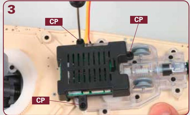
Befestigen Sie die Platinen-Box **17-01** mit den drei Schrauben **CP** am Getriebegehäuse-Unterteil **7-01**, wie es das Foto zeigt.
