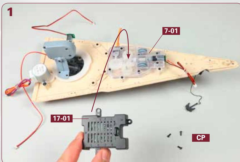
Nehmen Sie die Platinen-Box **17-01** und setzen Sie sie auf das Getriebegehäuse-Unterteil **7-01**, wie angedeutet. Legen Sie drei Schrauben **CP** bereit.
