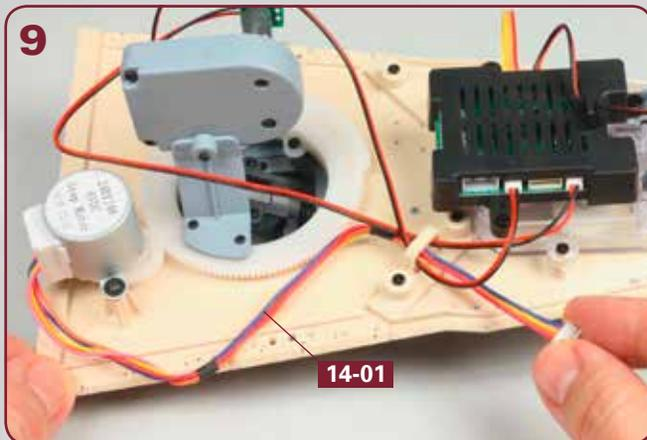
Das Kabel vom Schrittmotor **14-01** wird als drittes Kabel durch die große Öse auf der Unterseite des Oberdecks geführt, wie abgebildet.
