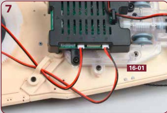
Der Stecker vom Kabel **16-01** gehört in den Port 8 der Platinen-Box, wie abgebildet.
