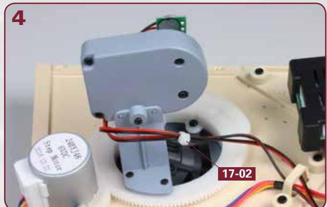
Das Foto zeigt den zurechtgeschnittenen und korrekt positionierten Kabelbinder **17-02**.
