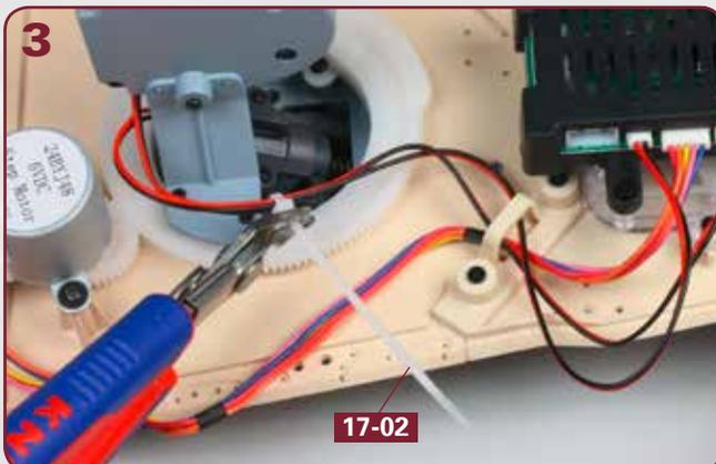
Schneiden Sie die überstehende Lasche des Kabelbinders **17-02** mit einem Seitenschneider oder einer geeigneten Schere ab.
