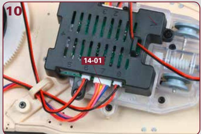
Der Stecker vom Kabel **14-01** gehört in den Port 7 der Platinen-Box. Auch die Litzen dieses Steckers weisen nach unten.
