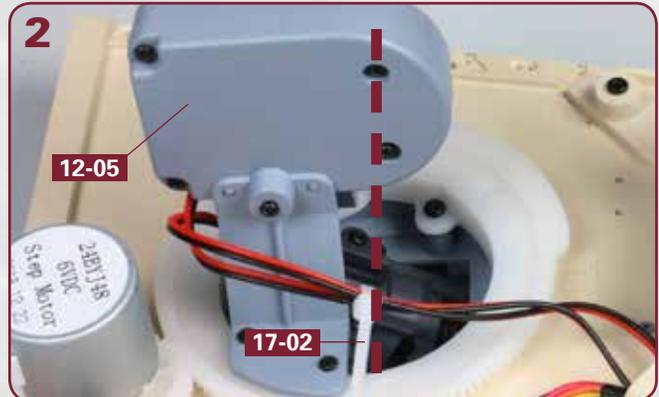
Ziehen Sie den Kabelbinder **17-02** um die beiden Kabel fest. Der Kabelbinder soll sich etwa auf Höhe der beiden vorderen Schrauben des Getriebehäuses **12-05** befinden (gestrichelte Linie).
