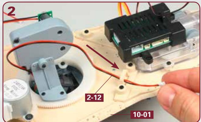
Führen Sie das Kabel vom Kadenz-Motor **2-12** durch die große Öse, die sich an der Unterseite vom Oberdeckabschnitt **10-01** befindet (Pfeil).
