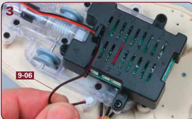
Drehen Sie das Oberdeck um und führen Sie den Stecker des Kabels **9-06** zum Port 2 (Pfeil) der Platinen-Box. Achten Sie auf die Ausrichtung des Steckers: Die sichtbaren Litzen weisen nach unten.
