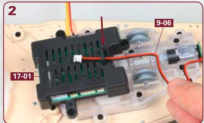
Führen Sie das Kabel vom Ankermotor **9-06** durch die Öse auf der Platinen-Box **17-01**, auf die der Pfeil weist.
