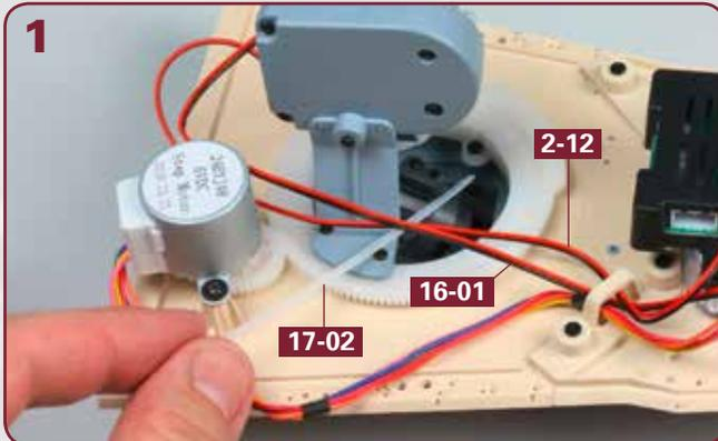
Nehmen Sie den Kabelbinder **17-02** und führen Sie ihn um die beiden Kabel **16-01** und **2-12** herum, wie angedeutet.
