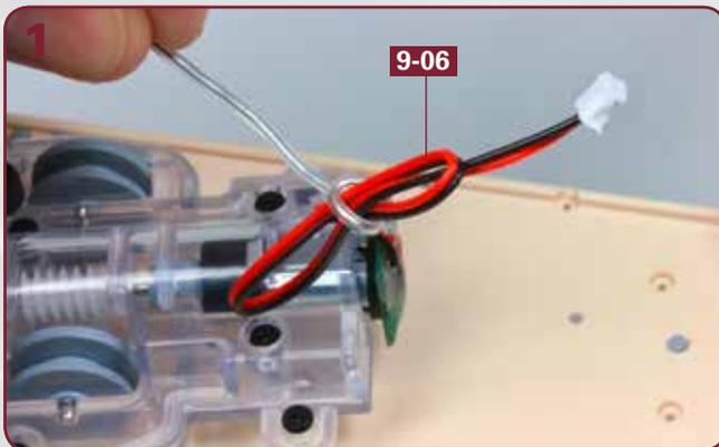
Nehmen Sie das Kabel vom Ankermotor **9-06** und entfernen Sie den Schutzdraht – falls Sie dies noch nicht getan haben.
