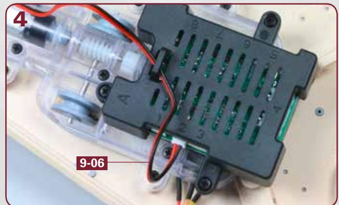
Der Stecker des Kabels **9-06** ist mit dem Port 2 der Platinen-Box verbunden.
