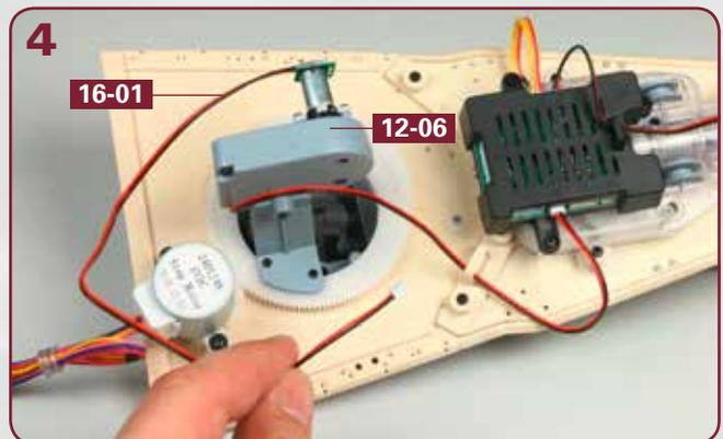
Nun folgt das Kabel vom Höhenrichtmotor **16-01**. Es wird hinter dem Getriebegehäuse **12-05/12-06** herumgeführt, wie es das Foto andeutet.
