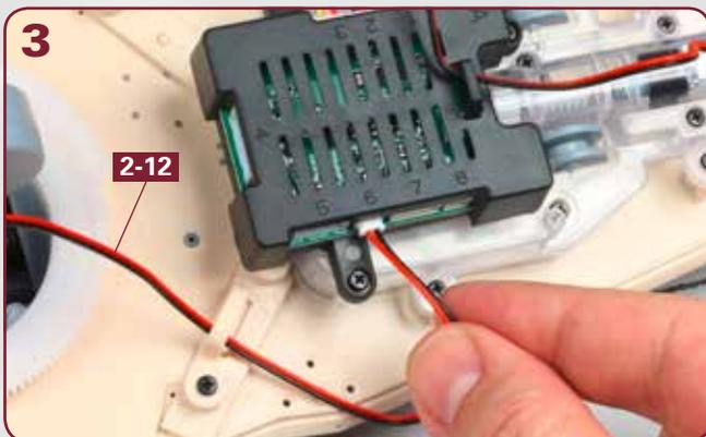
Der Stecker vom Kabel **2-12** wird in den Port 6 der Platinen-Box eingefügt. Die Litzen am Stecker befinden sich auf der Unterseite.
