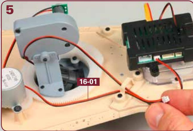
Auch das Kabel vom Höhenrichtmotor **16-01** wird durch die große Öse auf der Unterseite des Oberdecks geführt.
