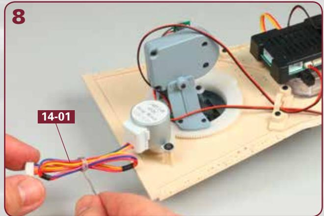
Als Letztes ist das Kabel vom Schrittmotor **14-01** an der Reihe. Entfernen Sie auch hier zunächst den Schutzdraht, wie angedeutet.
