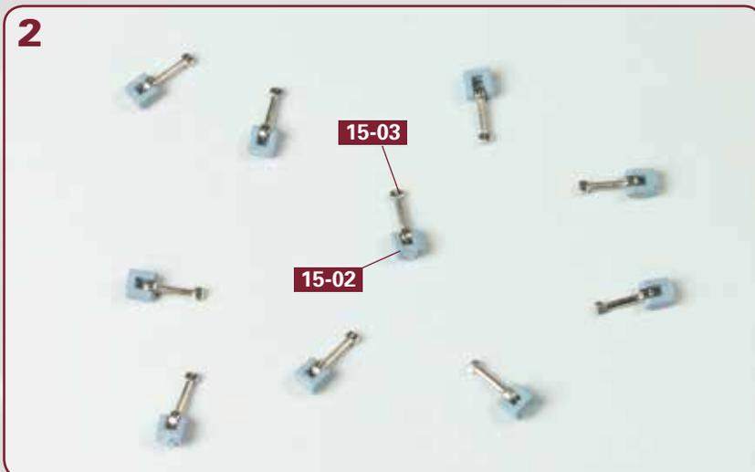
Wiederholen Sie den Vorgang mit neun weiteren Hebeln **15-03** und Gelenken **15-02**, sodass Sie insgesamt zehn Paare haben.
